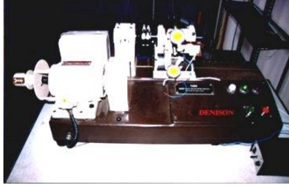
Şekil 3.15. Samuel Denison Ltd. yorulma test cihazı
