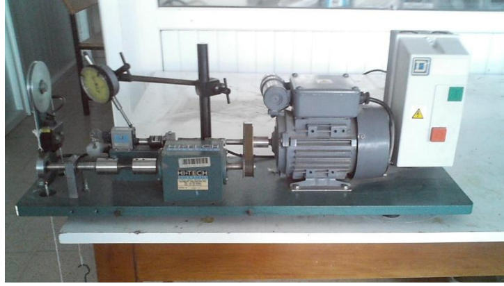
Şekil 3.17. Döner eğilmeli test cihazı
