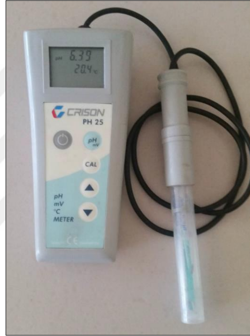
Şekil 2.7. Suyun pH, sıcaklık ve iletkenliğini ölçen CRISON PH-25 cihazı
