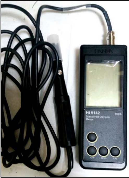
Şekil 2.6. Oksijen miktarını ölçen HANNA HI-9142 oksijen metre
