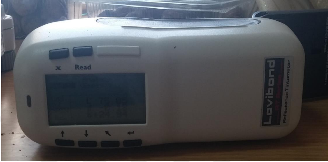
Şekil 3.2. Meyve kabuk ve iç renk ölçüm cihazı
