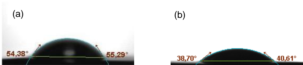
Şekil 4.20. Korozif ortama daldırılmamış bakır (a) ve 120 saat 0,1 mM VB2 içeren %3,5 NaCl çözeltisine daldırılmış bakır yüzeylerinin temas açıları
