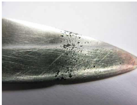
Şekil 1.3. Taneler arası korozyona uğramış bir bıçak (URL-3 2017)
