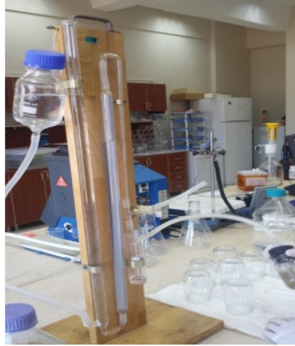
Şekil 3.4. Çalışma alanında alınan topraklarda karayolu uzaklıklarına göre kireç tayini
