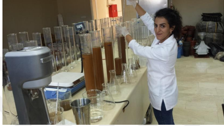
Şekil 3.3. Çalışma alanında alınan topraklarda karayolu uzaklıklarına göre tekstür analizi çalışması
