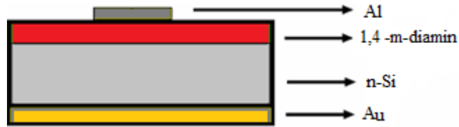
Şekil 4.3. Al/1,4-m-diamin/n-Si/Au diyotunun şeması
