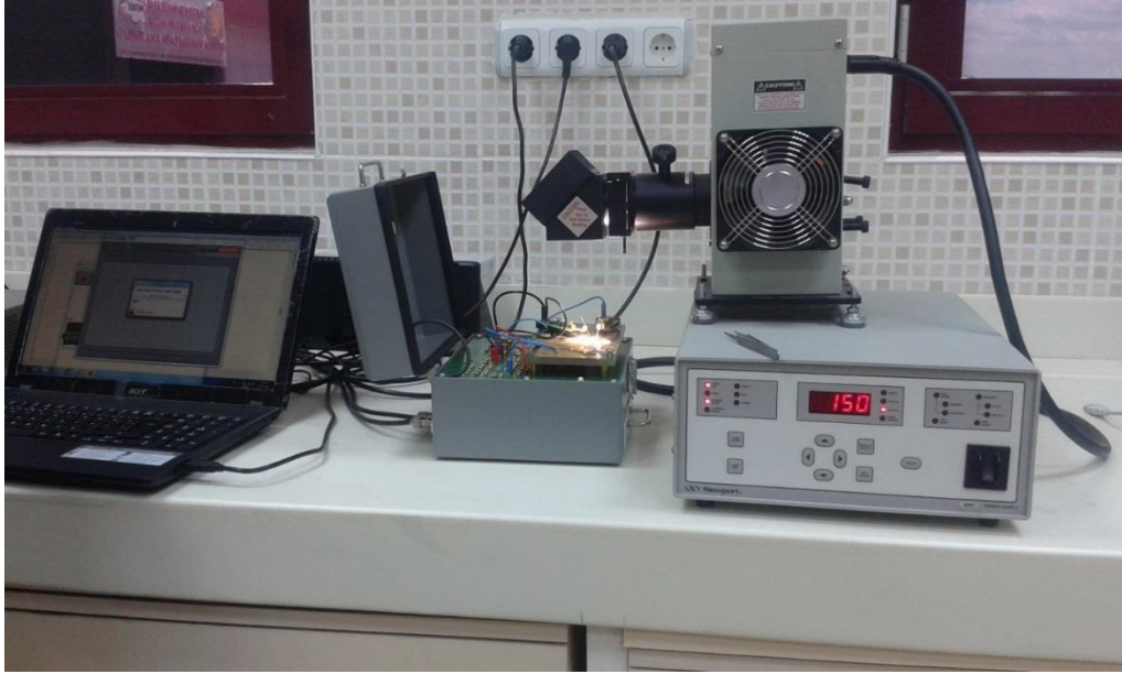
Şekil 5.8. Keitley 2400 Sourcementer ve güneş simülatörü
