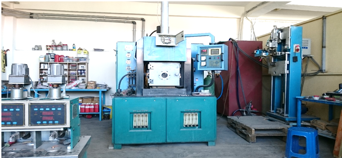
Şekil 4.3. Sıcak presleme işleminin yapıldığı cihaz
