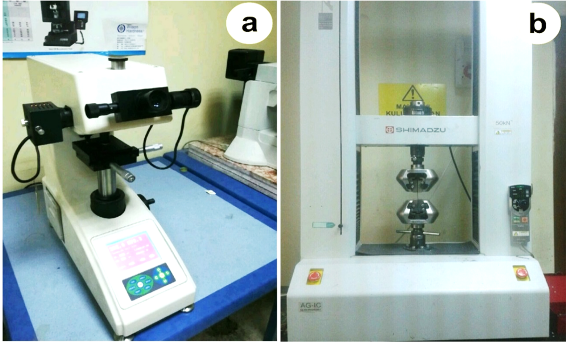
Şekil 4.5.a) Sertlik ölçümlerinde kullanılan cihaz, b) çekme testlerinde kullanılan cihaz
