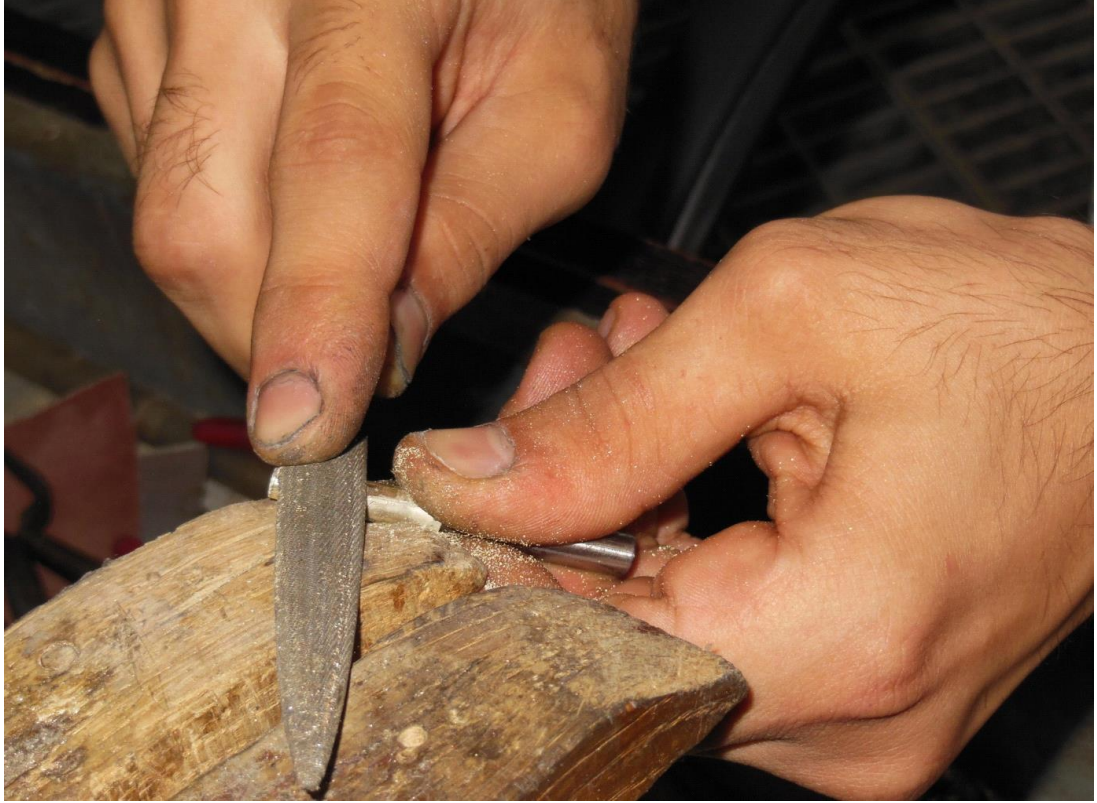
Resim 41: Aparatın dış kısmında kaynak sırasında oluşan fazlalıkların alınmasının görüntüsü (Fotoğraf: Anton Trofimov).
