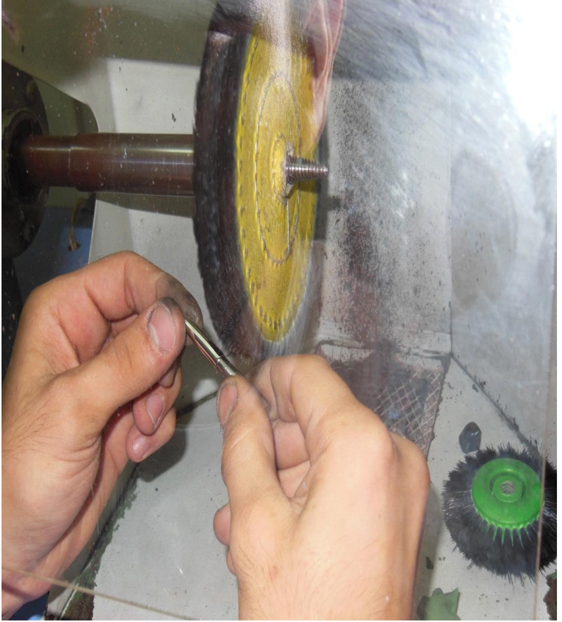
Resim 44: Keçe başlığı ile parlatılan gümüş aparatın görüntüsü (Fotoğraf: Anton Trofimov).
