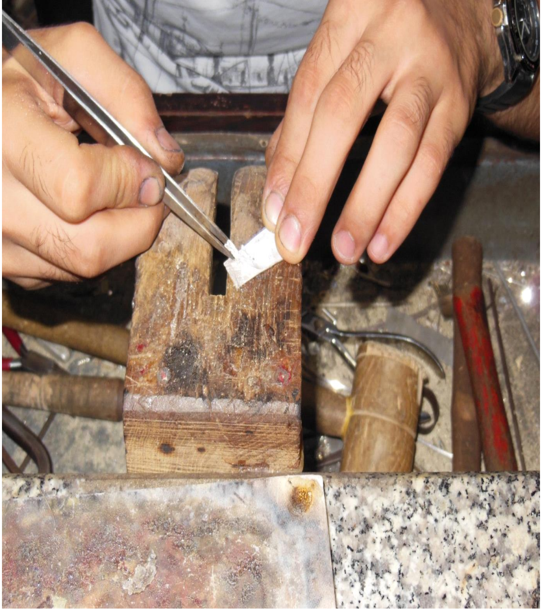
Resim 26: Gümüş levhanın üzerinden yapıştırılan kâğıt parçasının çıkartılmasının görüntüsü (Fotoğraf: Anton Trofimov).
