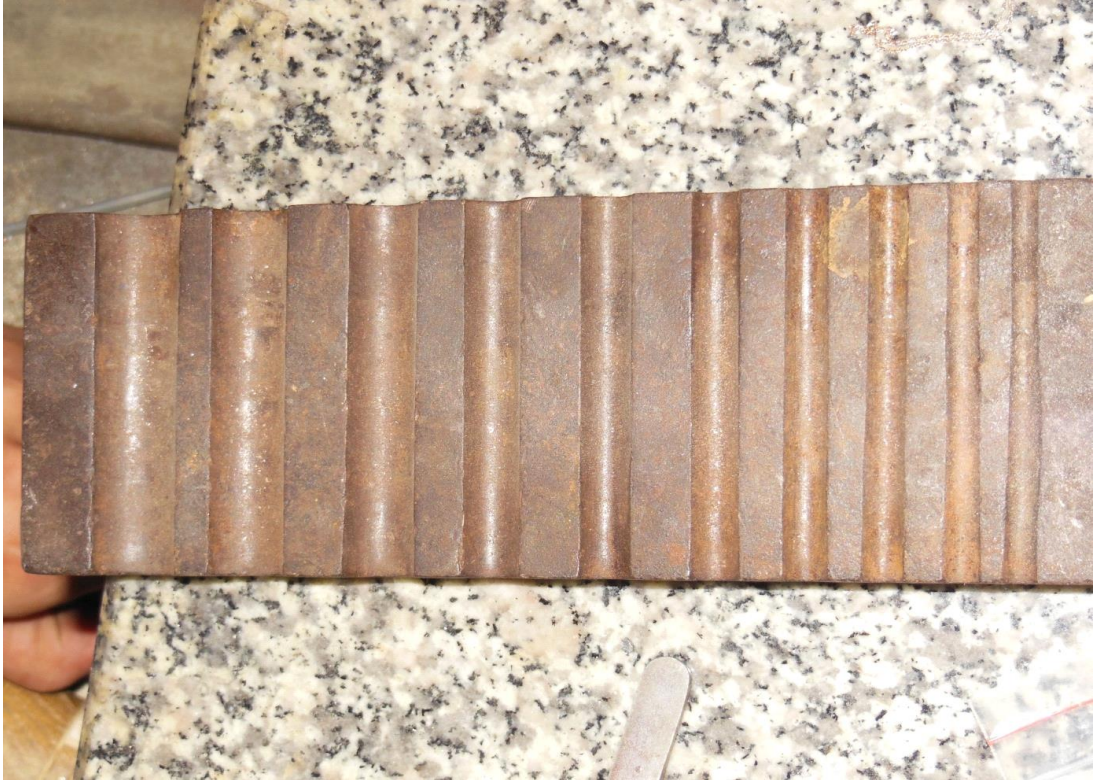
Resim 28: Düz levhanın boruya dönüştürülmesi için kullanılan aparatın görüntüsü (Fotoğraf: Anton Trofimov).
