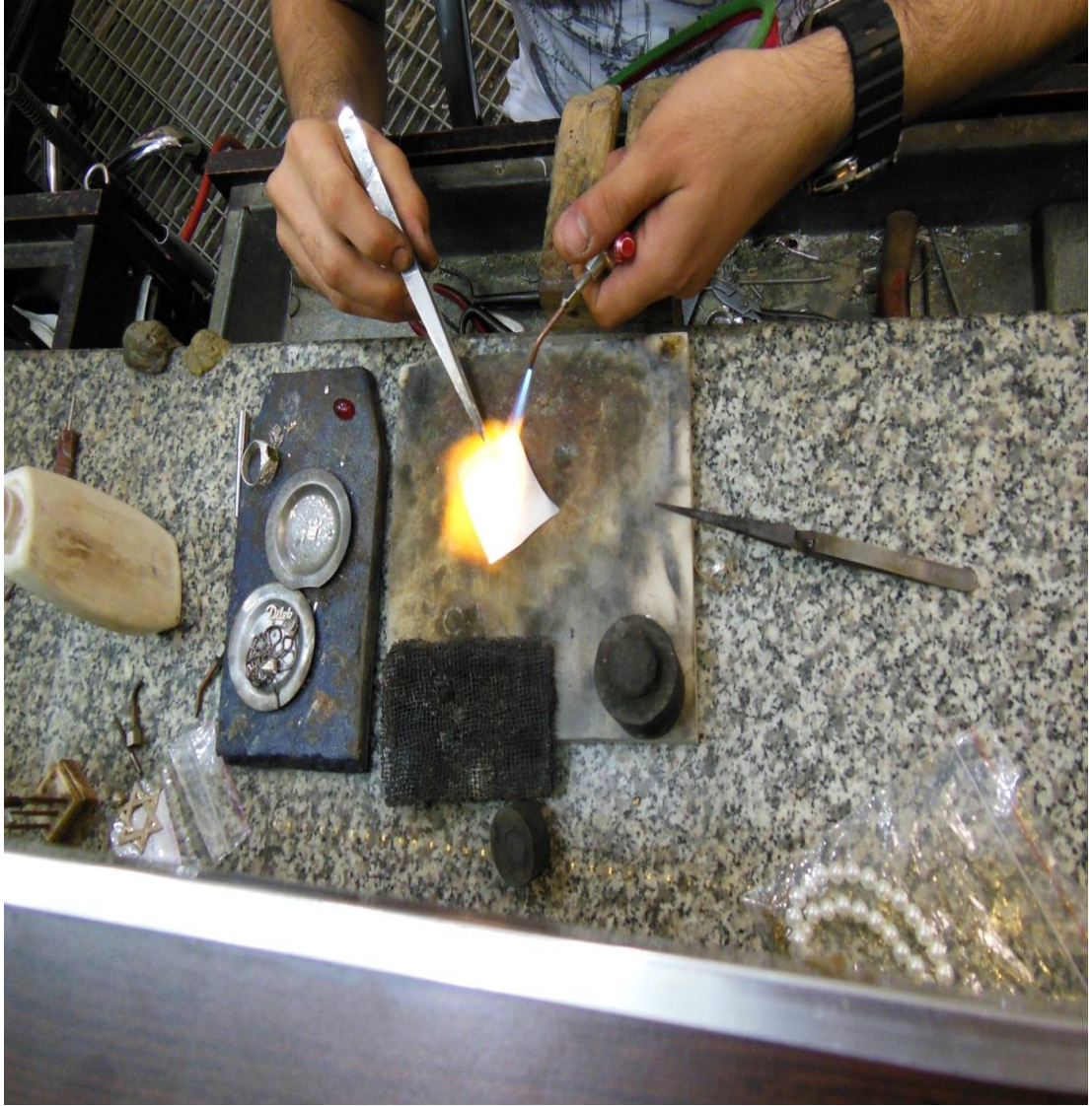
Resim 17: Gümüş levhanın esneklik sağlanması için oksijen kaynağı ile ısıtılmasının görüntüsü. (Fotoğraf: Anton Trofimov)
