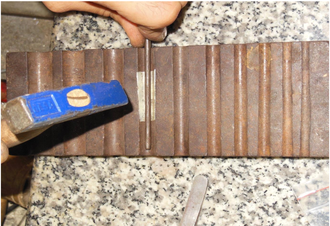
Resim 29: Gümüş levha boruya dönüştürülürken, yarıçapı gittikçe küçülen yarım dairesel oyuklara sahip olan aparatın görüntüsü (Fotoğraf: Anton Trofimov).
