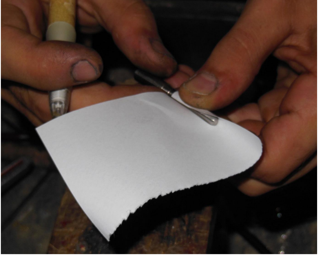
Resim 18: Şablonun şekline göre kâğıt parçasıyla üstünde ölçülerin alınmasının görüntüsü. (Fotoğraf: Anton Trofimov)
