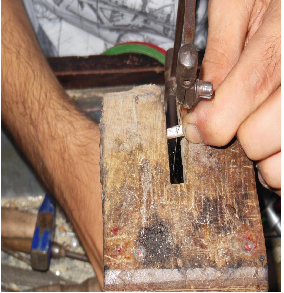
Resim 38: Aparatın numarasına göre fazlalığın kesilmesinin görüntüsü (Fotoğraf: Anton Trofimov).
