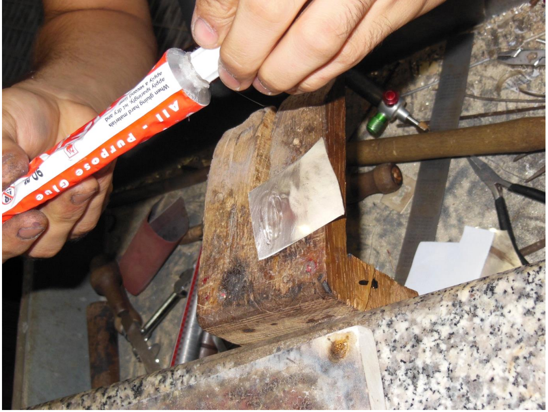
Resim 22: Aparat şablonuna göre kesilmiş kâğıt parçasının gümüş levhaya yapışması için yapıştırıcının sürülmesi (Fotoğraf: Anton Trofimov).
