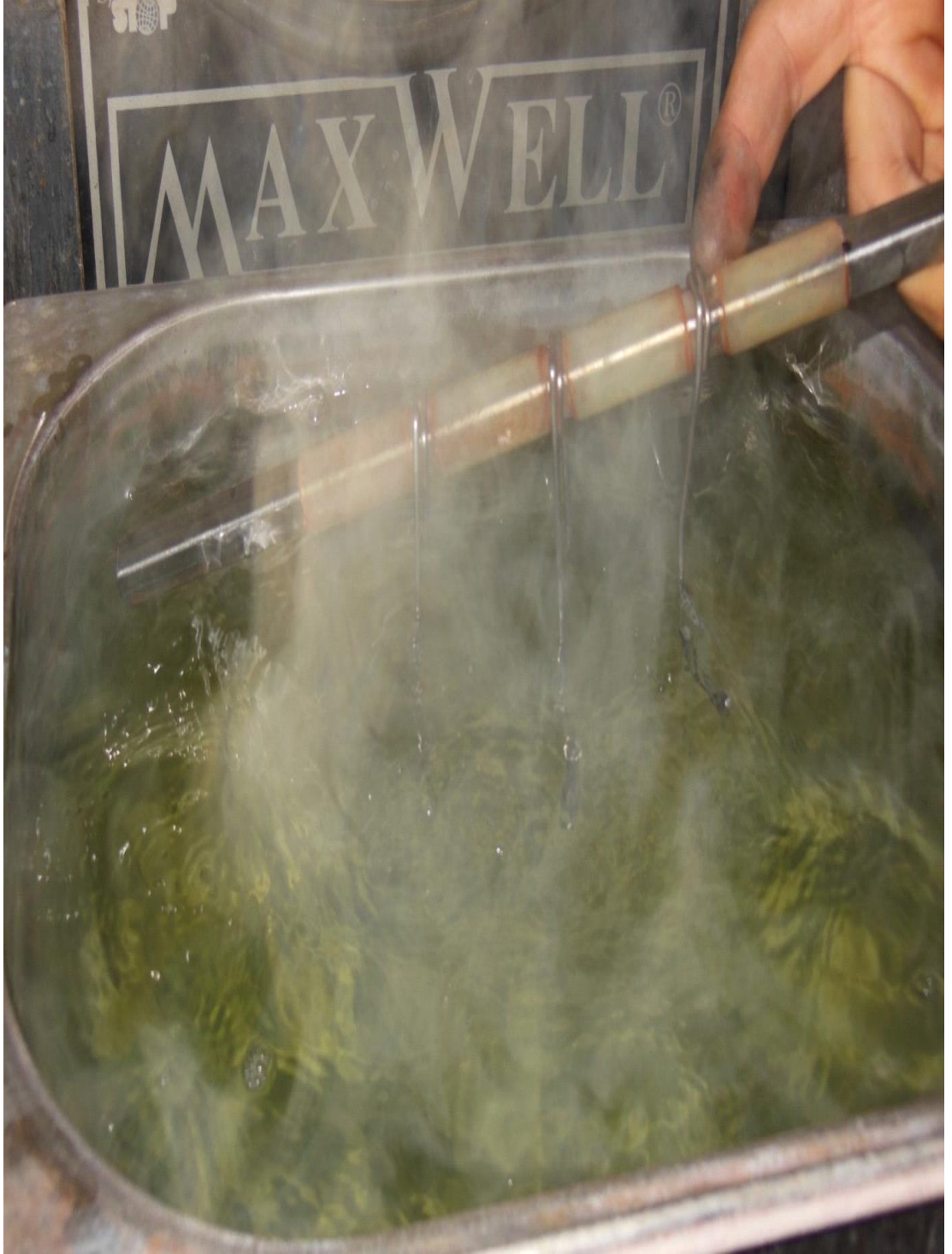
Resim 45: Parlatma sırasında aparatın içine birikmiş olan pisliğin alınması üzere, kaynayan titreşimli suya batırılmasının görüntüsü (Fotoğraf: Anton Trofimov).
