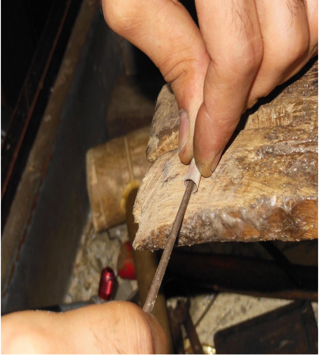
Resim 35: Aparatın içindeki kaynak fazlalıklarının alınması (Fotoğraf: Anton Trofimov).
