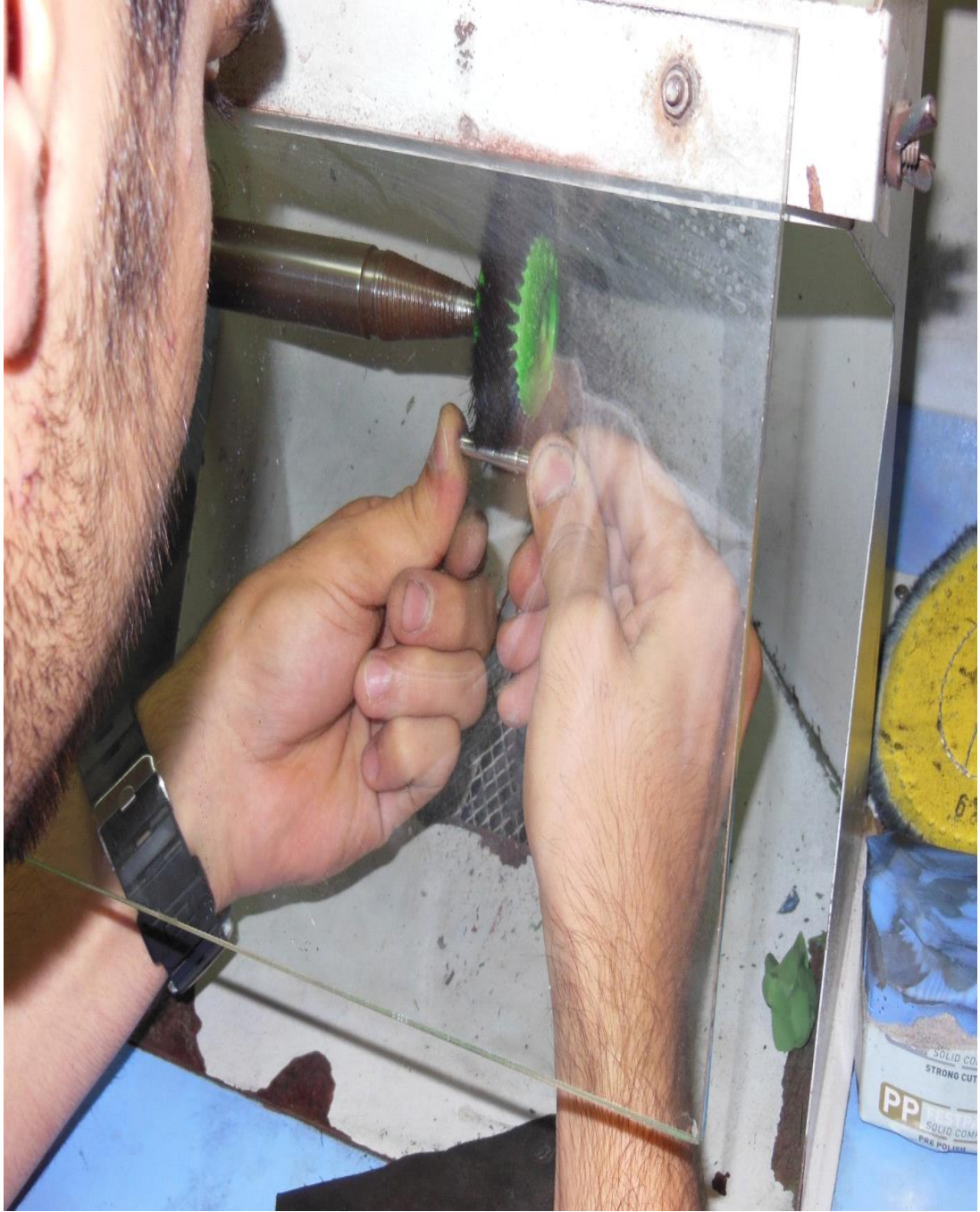
Resim 43: Aparatın fırçalı başlıkla parlatılmasının görüntüsü (Fotoğraf: Anton Trofimov).
