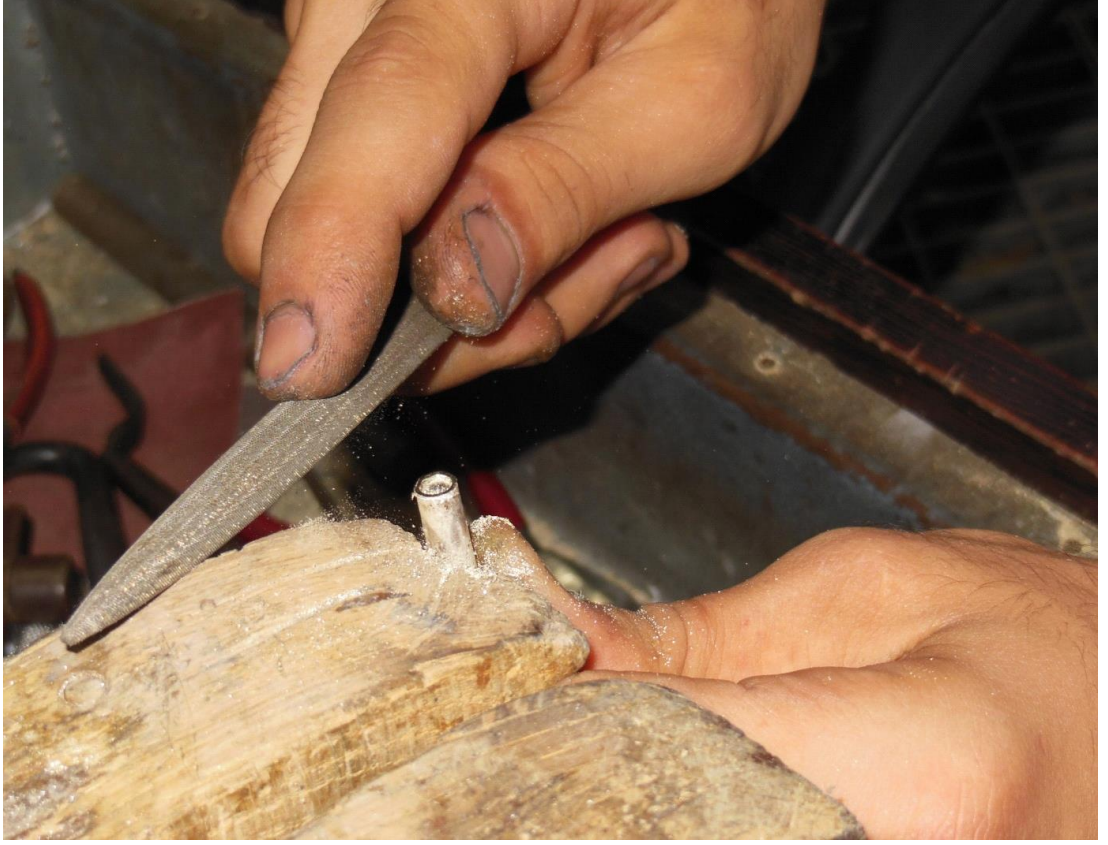
Resim 40: Aparatın üstünde testerenin bıraktığı mikro tırtıkların yok edilmesinin görüntüsü (Fotoğraf: Anton Trofimov).
