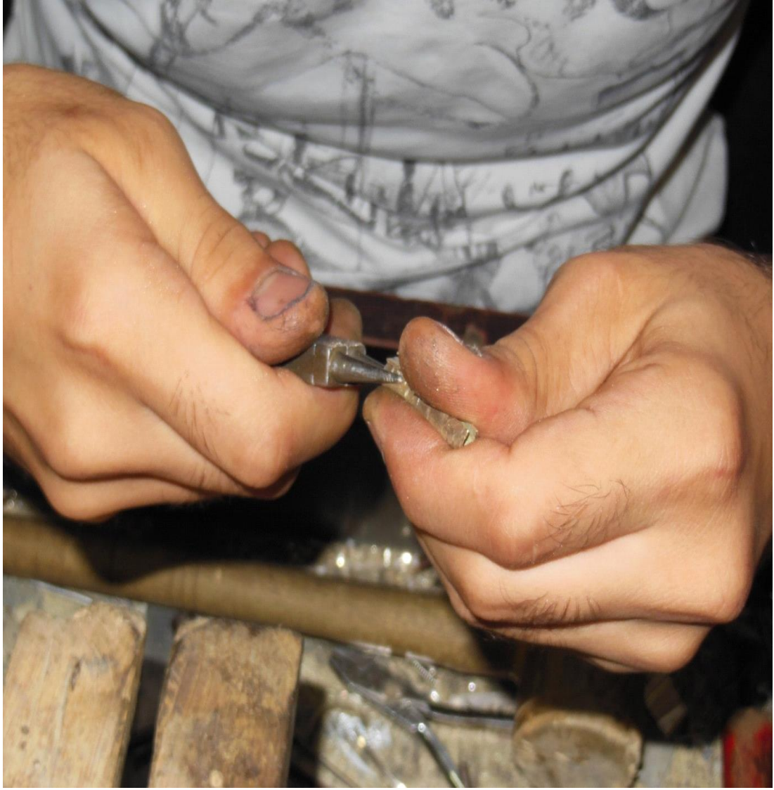
Resim 31: Aparata benzemeye başlayan borunun kaynatılmasından önce, yuvarlak uçlu penseyle ince ayarın yapılmasının görüntüsü (Fotoğraf: Anton Trofimov).
