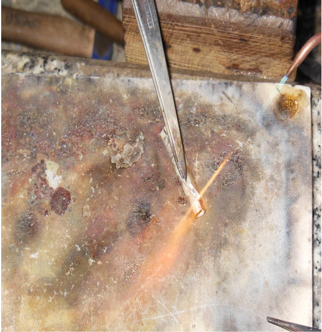
Resim 33: Aparatın boru kaynak hattının gümüş kaynağı ile kaynatılmasının görüntüsü (Fotoğraf: Anton Trofimov).
