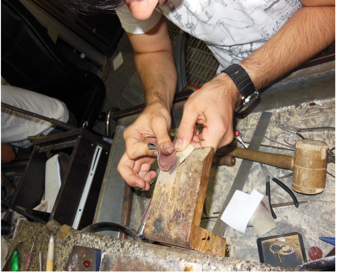
Resim 21: Gümüş levhanın üstünden mikro kabarıklıkların almasının görüntüsü (Fotoğraf: Anton Trofimov)
