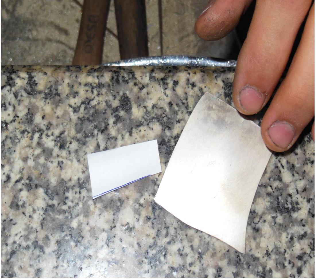
Resim 19: Fagot entonasyonunu pesleştiren aparatın şablonuna göre kesilmiş kâğıt parçası ve yanında gümüş levhanın görüntüsü. (Fotoğraf: Anton Trofimov)
