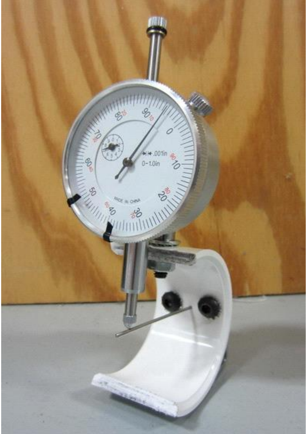
Resim 16: Fagot entonasyonunu pesleřtiren aparatın metal kalınlıėını lerken kullanılan Mikrometre makinasının grnts. (Fotoėraf: Anton Trofimov)
