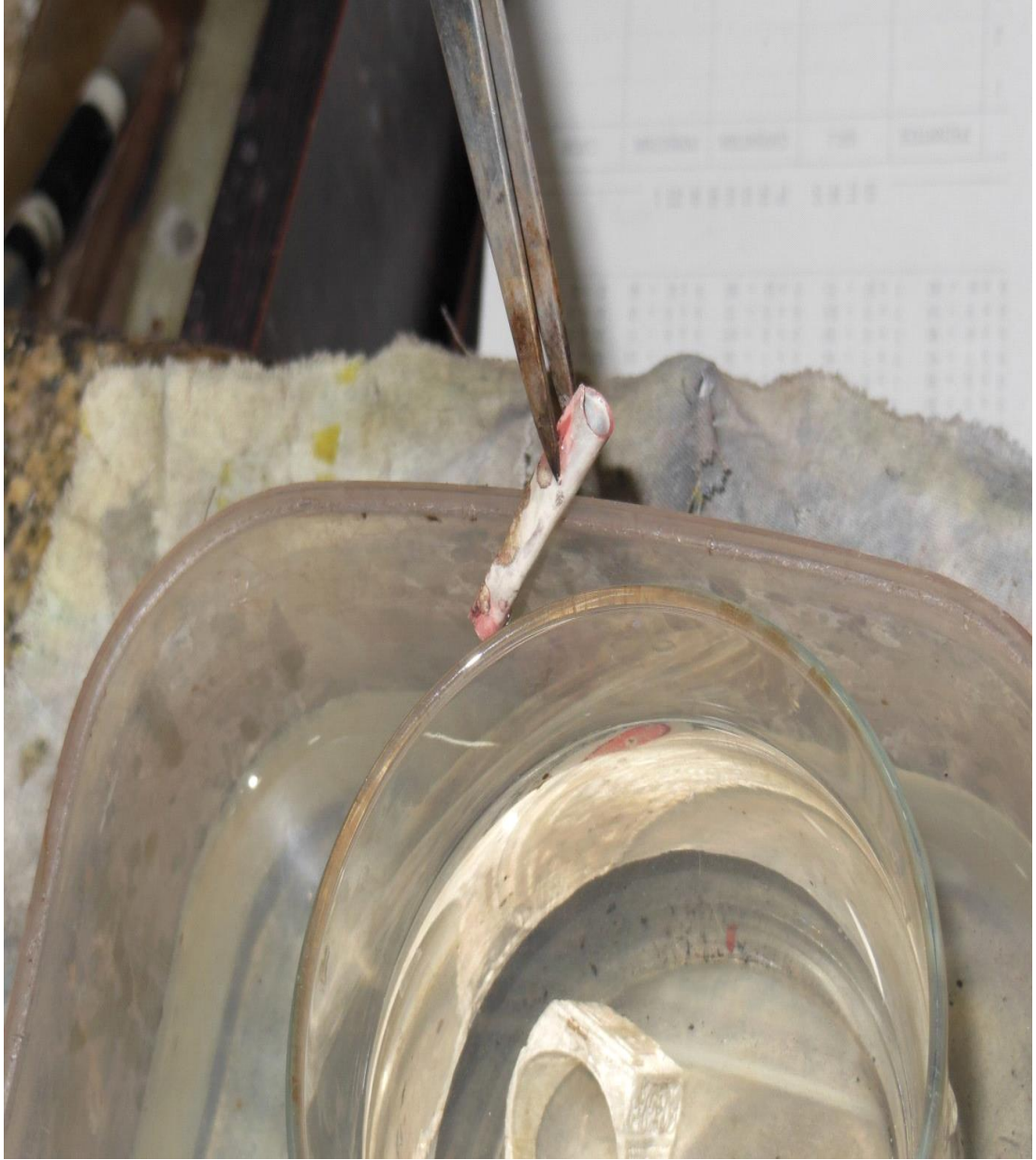
Resim 34: Kaynaktan çıkmış aparat madeninin tekrar sertleşmesini sağlamak için şoklanmak üzere suya atılırken görüntüsü (Fotoğraf: Anton Trofimov).
