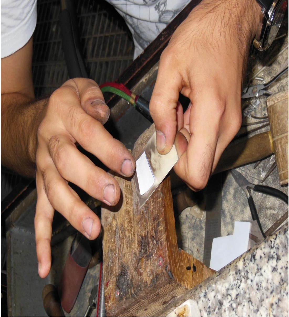
Resim 23: Aparat şablonuna göre kesilmiş kâğıt parçasının gümüş levhaya yapıştırılmasının görüntüsü (Fotoğraf: Anton Trofimov).
