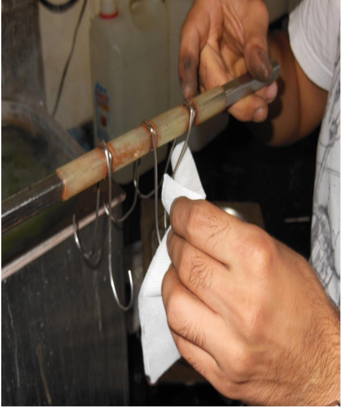
Resim 46: Kaynayan titreşimli sudan çıkmış temiz aparatın saf alkollü mendil ile silinmesinin görüntüsü (Fotoğraf: Anton Trofimov).
