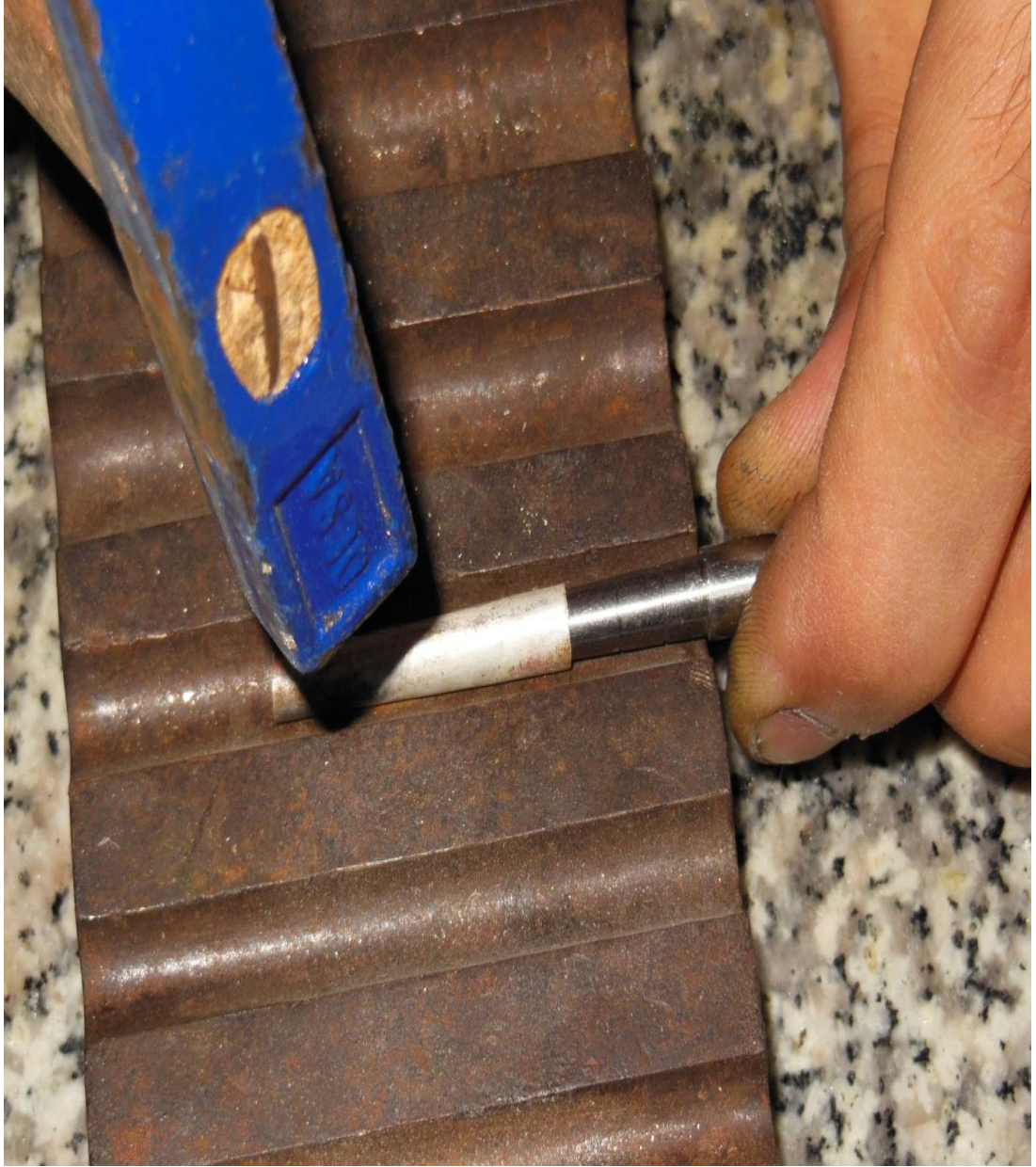
Resim 37: Aparatın boru kanalının ideal düzlükte olabilmesi için yapılan işlemin görüntüsü (Fotoğraf: Anton Trofimov).
