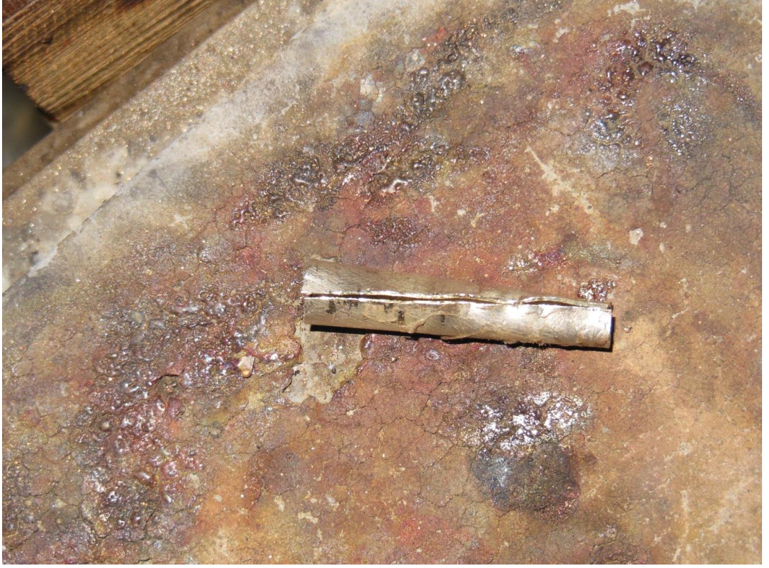
Resim 32: Fagot entonasyonunu pesleřtiren aparatın boru kaynak hattının kaynatılmasından önceki görünümü (Fotoğraf: Anton Trofimov).
