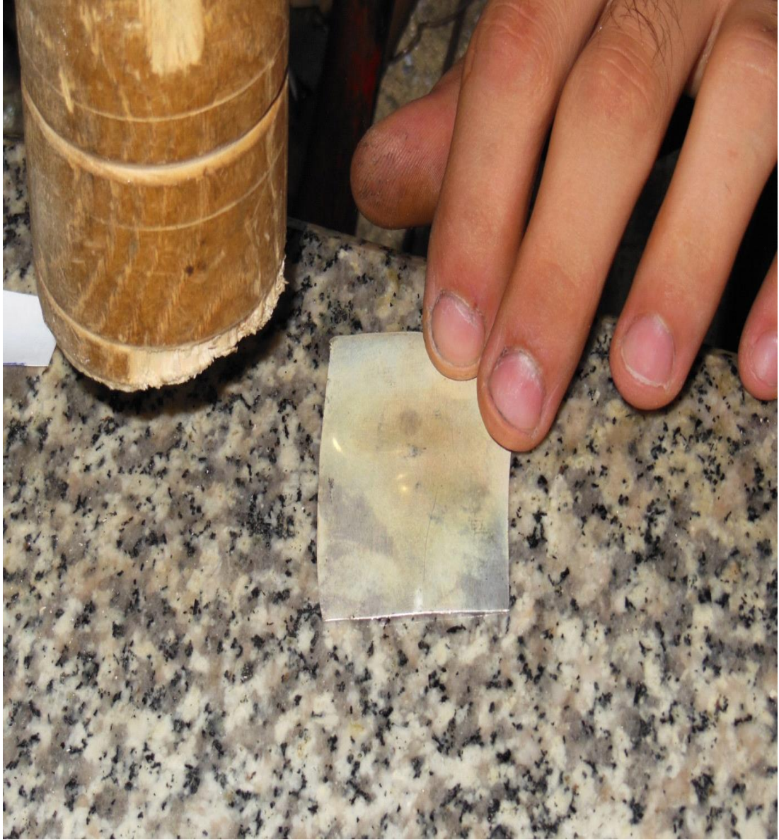
Resim 20: Gümüş levha esnek olması amacıyla ısıtılmasından sonra oluşan yamuklukların tahta çekiçe düzeltilmesinin görüntüsü (Fotoğraf: Anton Trofimov).
