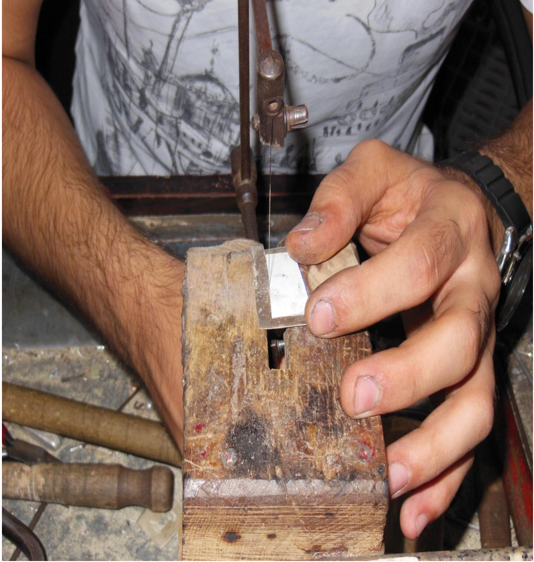
Resim 24: Aparat şablonuna göre kesilmiş kâğıt parçasının, gümüş levhanın üzerinde kesilmesinin görüntüsü (Fotoğraf: Anton Trofimov).
