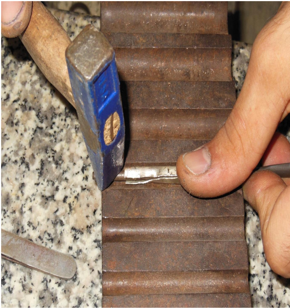
Resim 30: En küçük oyuğa yaklaştıkça levhanın nasıl bir boruya dönüştüğünün görüntüsü (Fotoğraf: Anton Trofimov).
