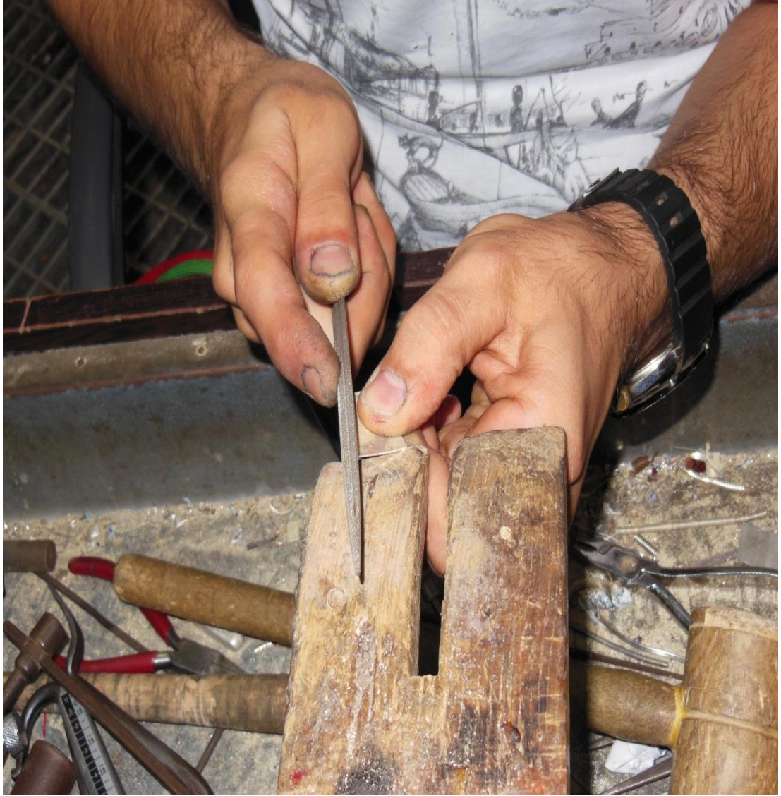
Resim 27: Gümüş levhanın üzerinde, kesim sonrası oluşan tırtıkların yok edilmesinin görüntüsü (Fotoğraf: Anton Trofimov).
