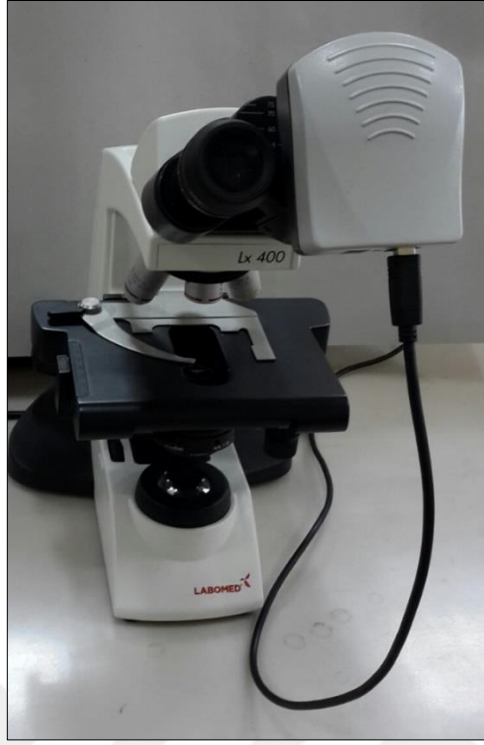
Şekil 2.11. Işık mikroskobuna monte edilmiş Scope Image marka 5 MP oküler kamera
