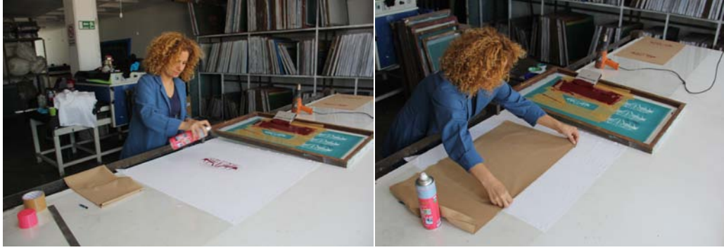
Resim 56: Baskı yapmak için, masa yüzeyine spreyle kumaşın sabitlenmesi
