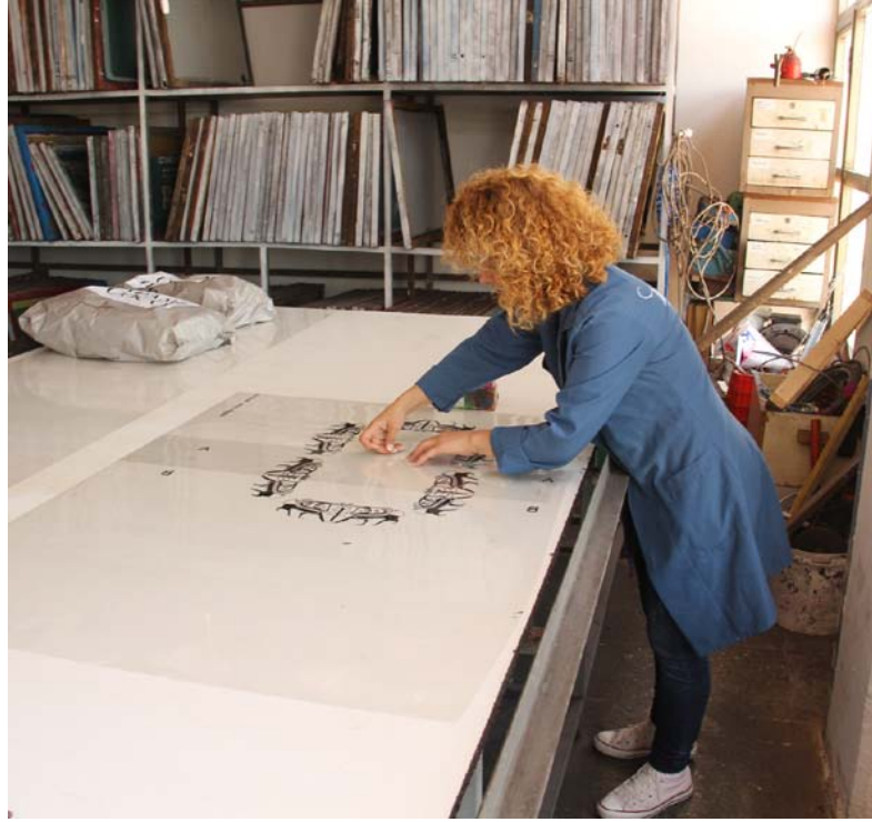
Resim 48: Filmin montajlanma aşaması
