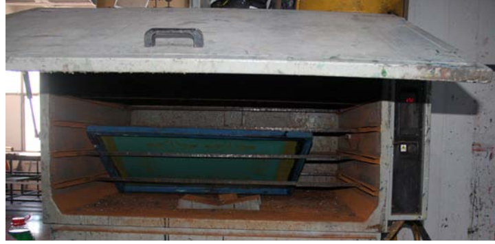
Resim 53: Banyo sonrası ipeğin kuruması için kurutma dolabına yerleştirilip kurumasının beklenmesi
