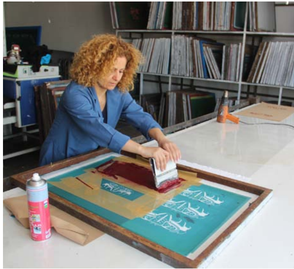
Resim 57: Serigrafi baskı, rakle yardımıyla boyanın kumaşa aktarılması
