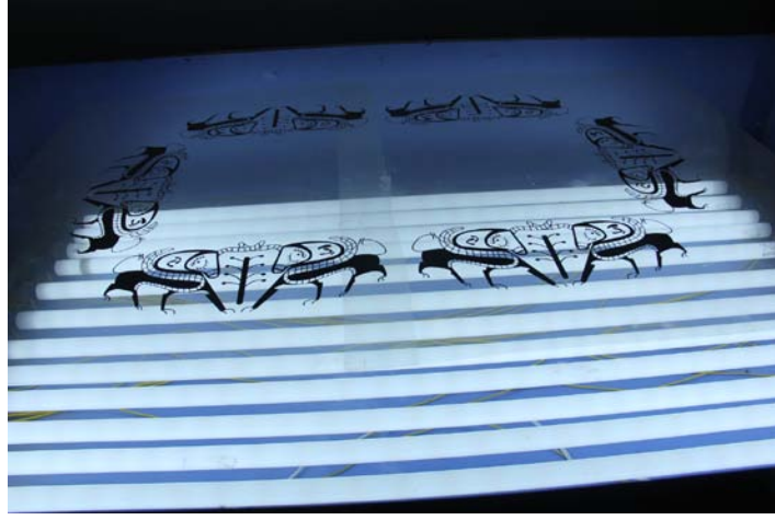
Resim 49: Işık kaynağı olarak masa genişliğine göre yeterli floresan lambaya sahip ışıklı masanın üzerine ipeğe pozlanacak olan asetat çıktının yerleştirilmesi
