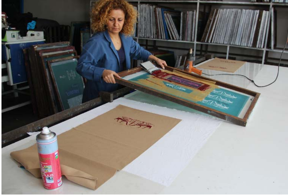
Resim 58: Baskının kumaş yüzeyine düzgün bir şekilde basılması.
