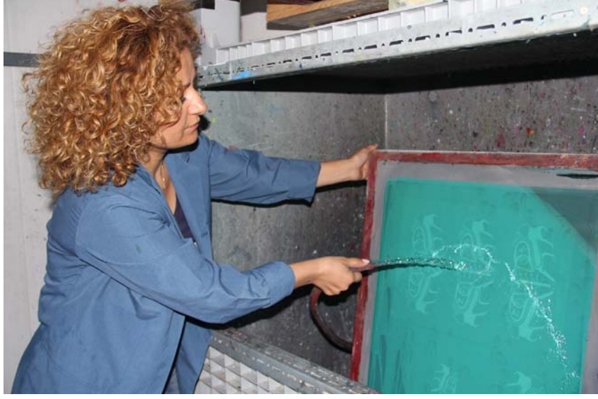
Resim 52: İpekte ışık almayan emülsiyonların, ıslatılarak sonrada su püskürtülerek dökülmesi, için yıkaması
