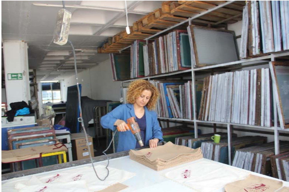
Resim 59: Serigrafi baskısı yapılan kumaş yüzeylerinin fön makinesiyle kurutulması
