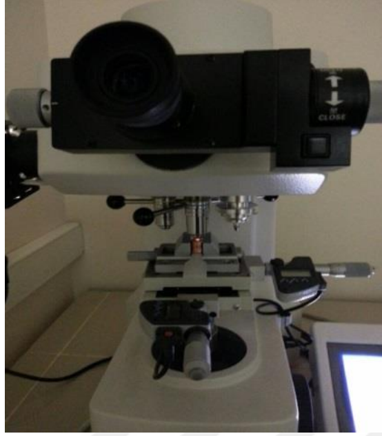
Şekil 4.8. Numunelerin sertliğinin ölçülmesi
