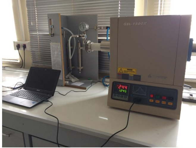
Şekil 4.5. Sinterleme esnasında kullanılan Protherm GSL-1500X marka tüp fırın
