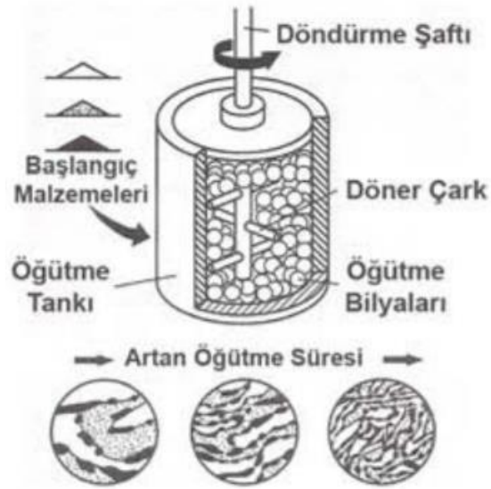
Şekil 3.6. Mekanik alaşımlama yöntemi (German 1994)
