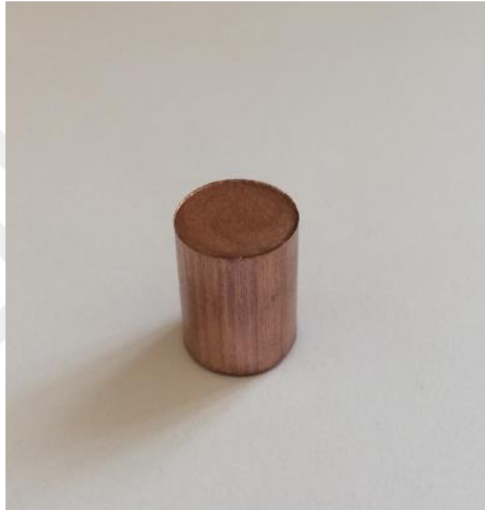
Şekil 4.4. Preslenmiş toz numune
