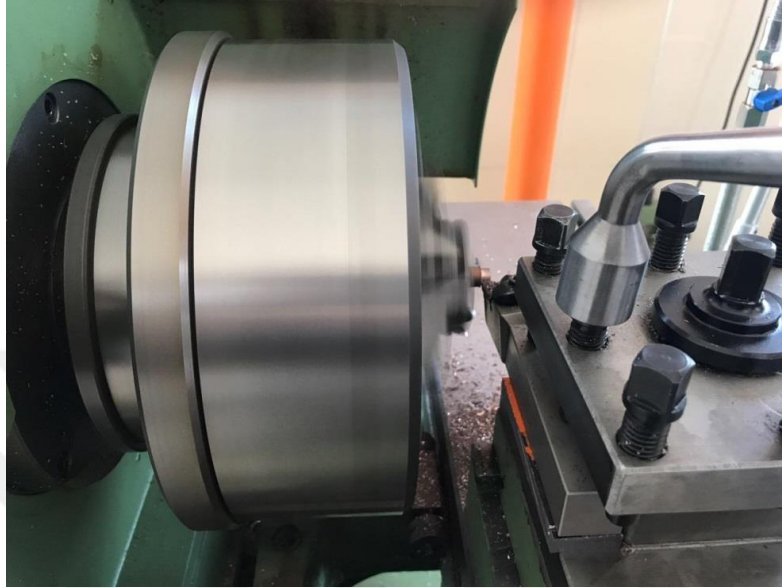
Şekil 4.10. Numunelerin Aşınma deneyine hazırlanması
