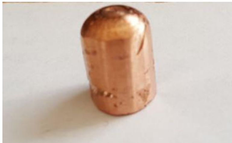
Şekil 4.11. Talaşlı imalat sonrası R4 radyusa sahip olan numune
