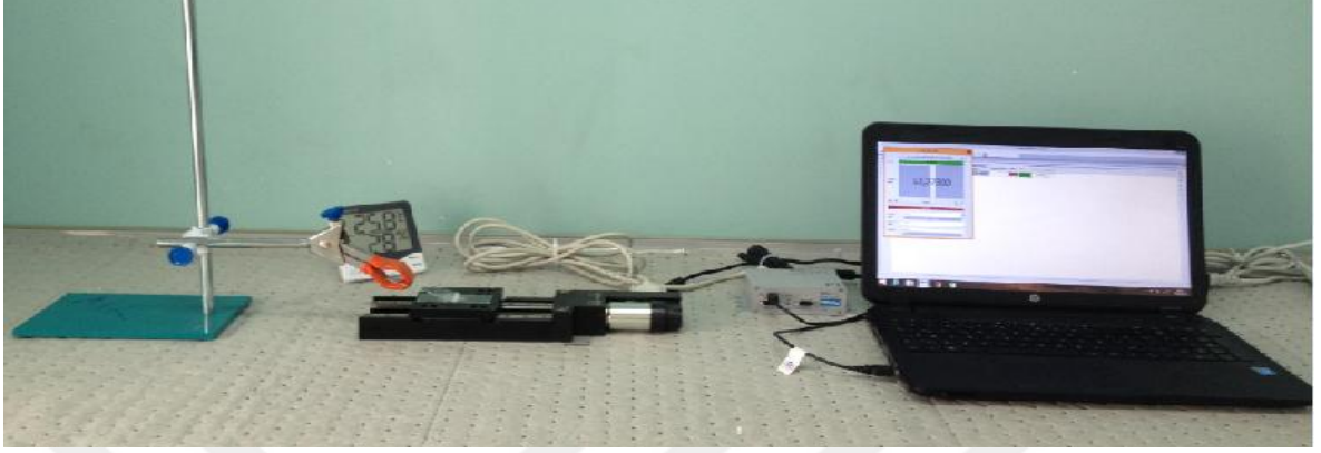
Şekil 3.1. Deney düzeneğine cam slaytların konulması ve cam slaytlar arası açının ayarlanması (Kahraman vd 2017; Yüksel 2017)
