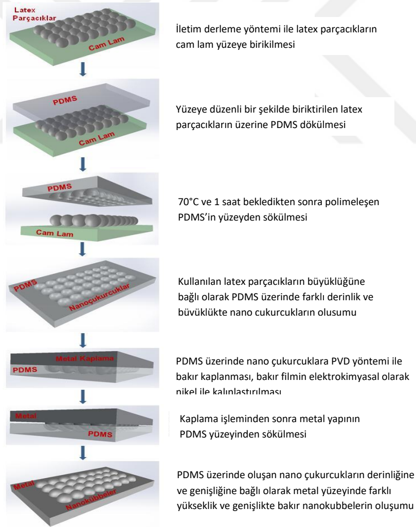
Şekil 4.1. 3D Cu-NDs hazırlanma basamakları (Kahraman vd 2017; Yüksel vd 2017; Taşçı 2017)
