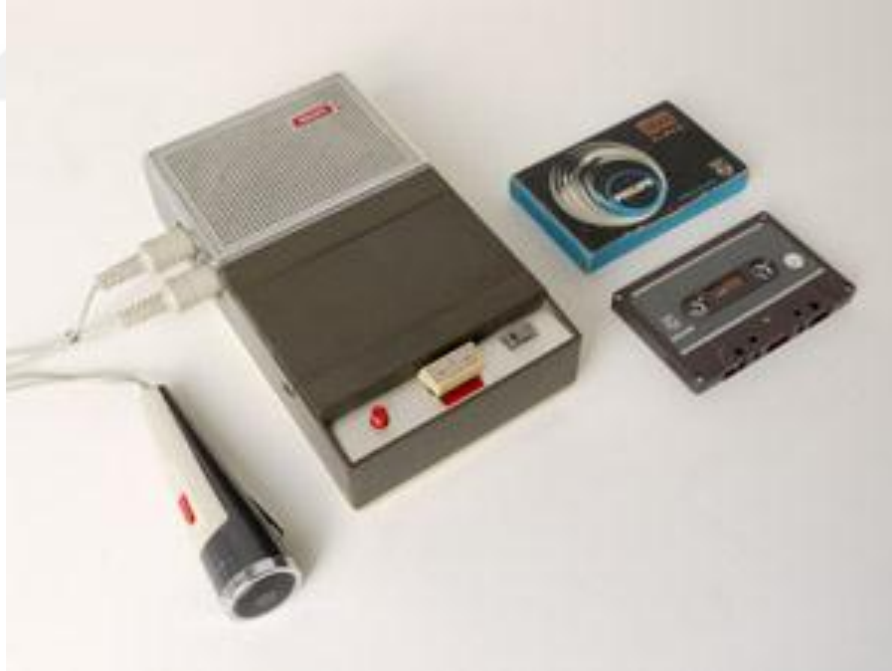
Fotoğraf 18. İlk Kasetçalar - Type EL3300 / “Philips Compact Cassette”. (b.t.). Erişim tarihi: 29.03.2016, http://www.philips-historische-producten.nl/cassette-uk.html
