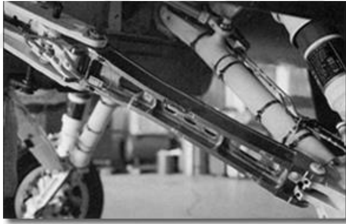
Şekil 2.2. Titanyum matrisli F-16 iniş takımları (Toptan 2006)
