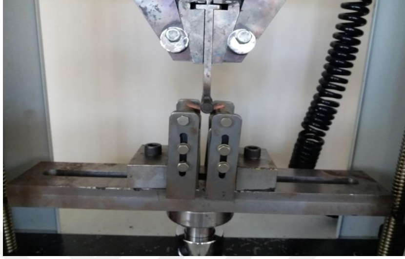
Şekil 4.3. Üretilen kompozitin eğilme deneyi makro fotoğrafı
