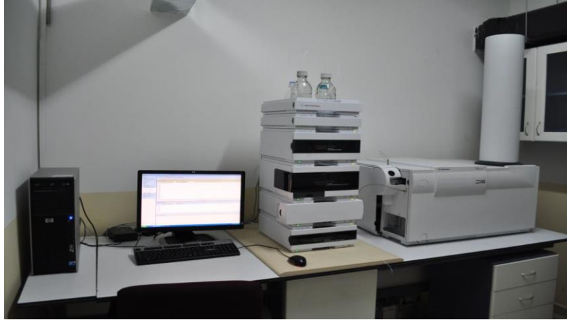
Şekil 3.4. Hidrofilik bileşenlerin kantitatif analizinde kullanılan HPLC-TOF/MS spektrometresi
