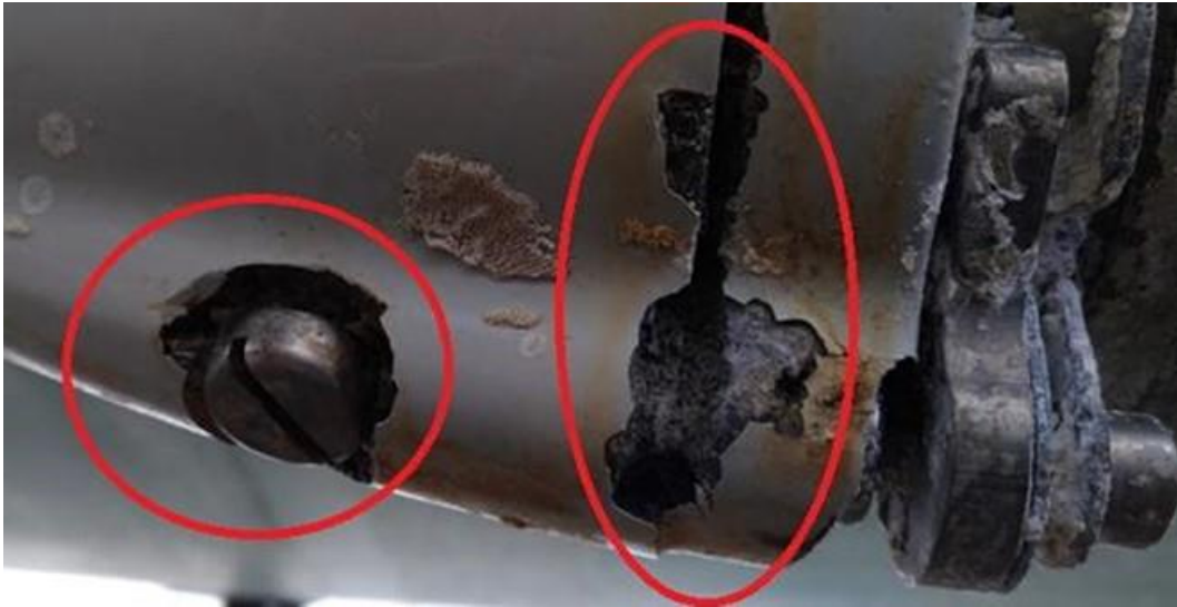
Şekil 1.2. Sudaki bir teknenin galvanik korozyonu (URL-2 2018)
