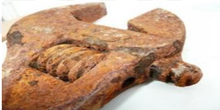
Şekil 1.1. Homojen korozyona uğramış yıldız anahtar (URL-1 2018)
