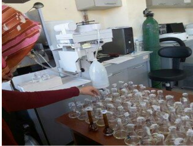
Şekil 3.1. DTPA Ekstraksiyon Yöntemiyle Fe, Cu, Mn, Zn Okuması
