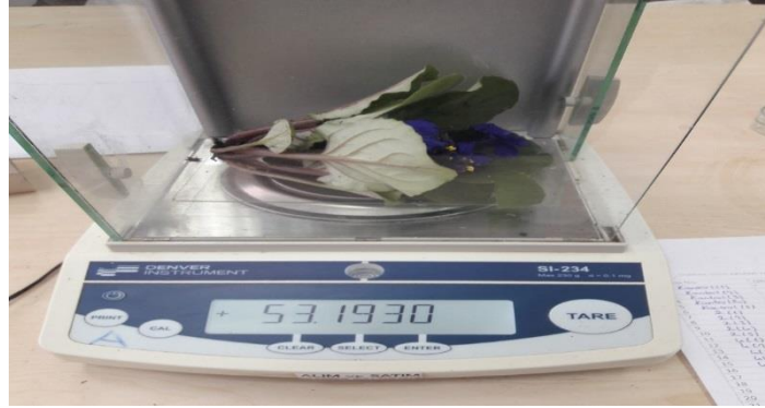
řekil 3.2. Hassas terazide bitki yař aęırlıęı ölçme
