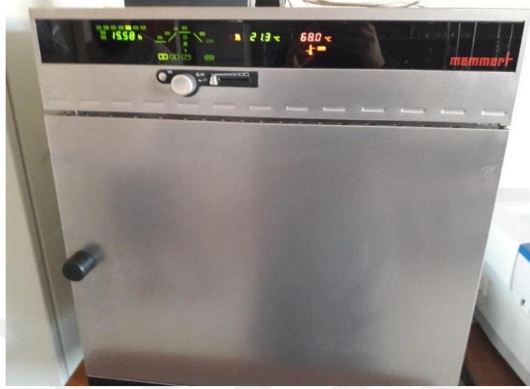
Şekil 3.3. Etüv cihazında bitkilerin kurutulması
