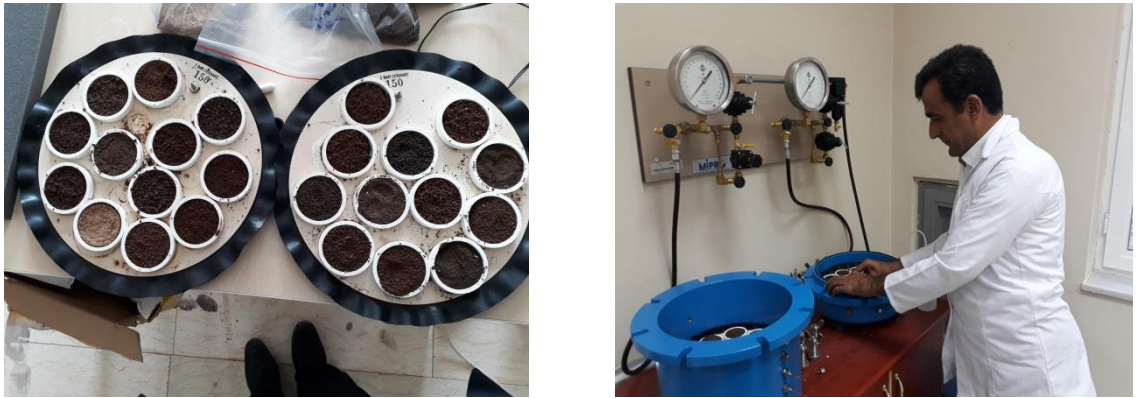
Şekil 3.5. Tarla kapasitesi ve Solma noktası analizleri yapımı
