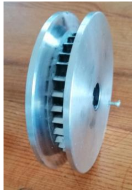
Şekil 3.10. Deneylerde kullanılan kasnakların fotoğrafı
