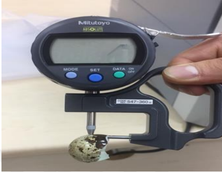
Şekil 3.3. Dijital mikrometre ile yumurta kabuk kalınlığının ölçümü
