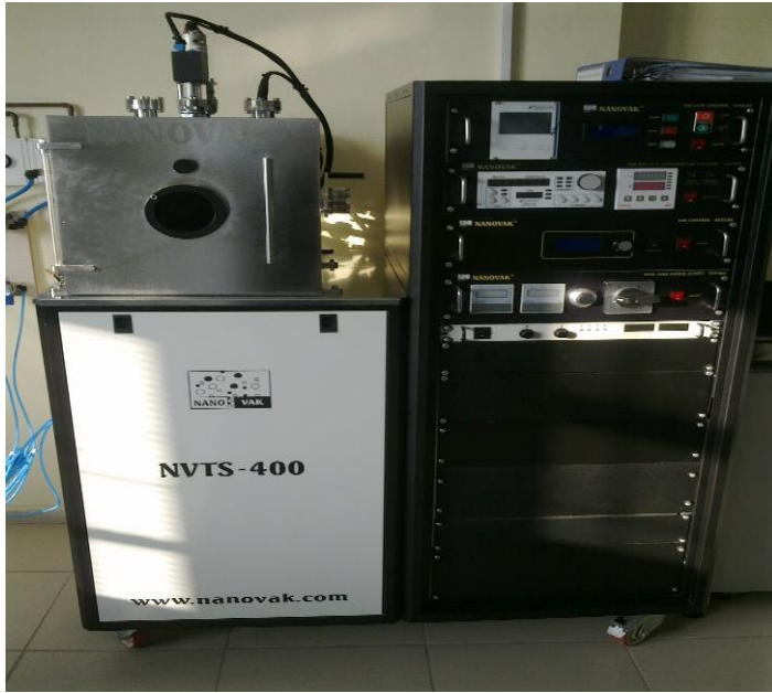
Şekil 3.19. NVTS 400 Manyetik alanda DC saçtırma ve termal buharlaştırma ünitesi
