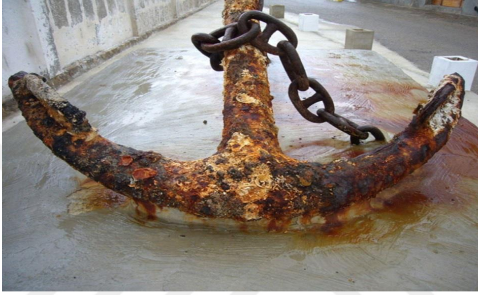
Őekil 1.8. Biyolojik korozyona uğramıő gemi apası (URL-6, 2019)
