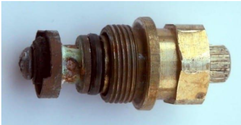
Şekil 1.7. Pirinç vanada oluşan seçici korozyon sonucunda çinkonun alaşımdan uzaklaşması (URL-5, 2019)
