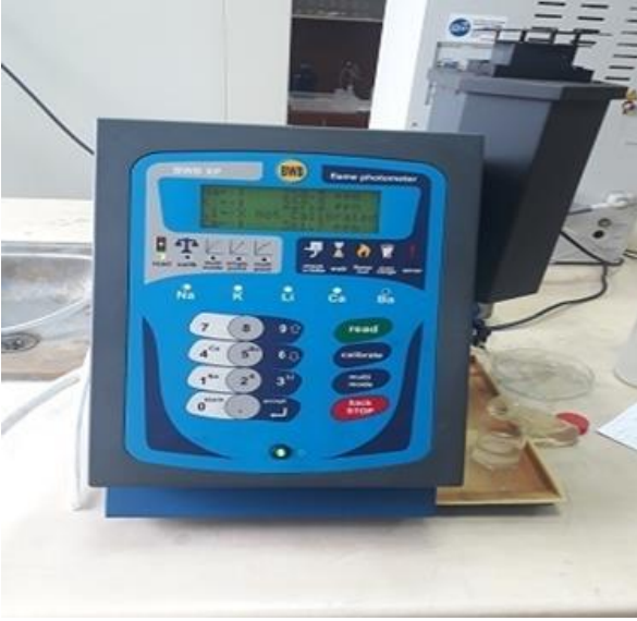
Şekil 3.22. Yakılan bitkilerde Na ve K değerlerinin okunması
