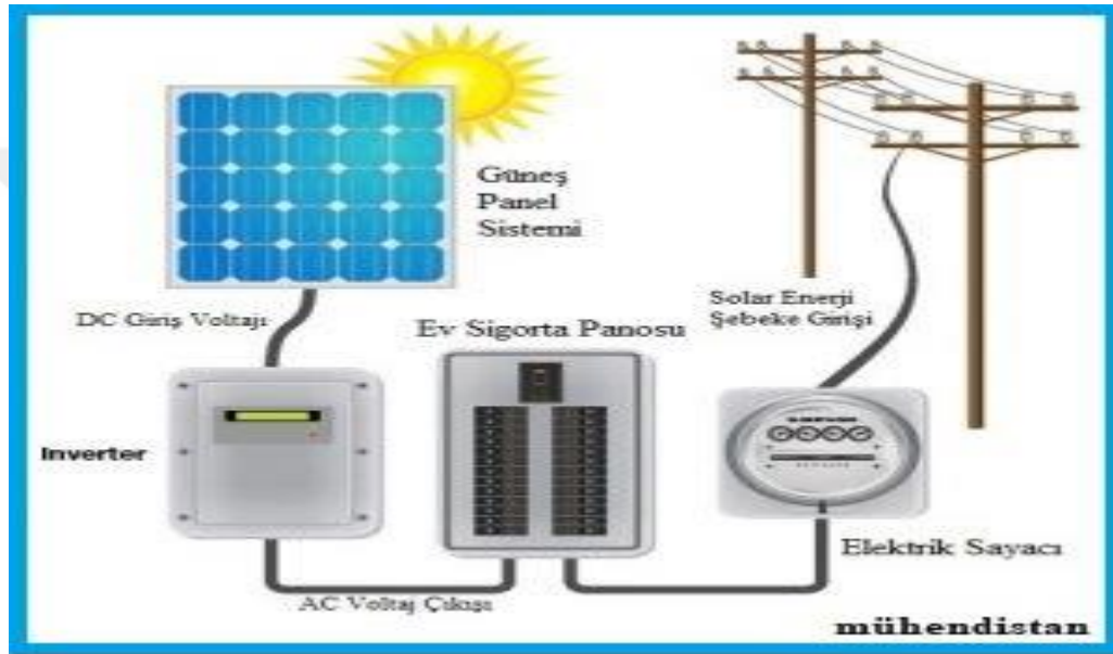
Şekil 2.20. Şebekeye paralel sistem uygulaması (URL 11)
