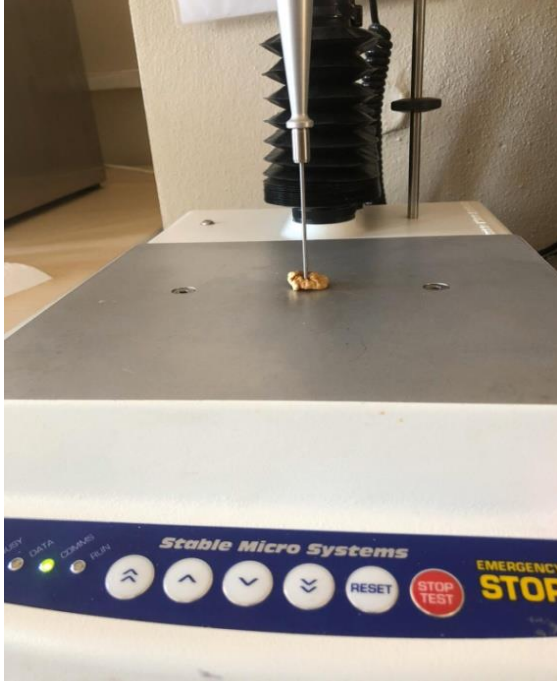
Şekil 3.8. Meyve iç sertlik değeri ölçüm cihazı
