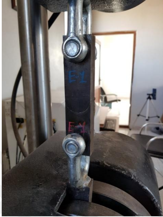
Şekil 2.9. Deney numunesinin test cihazına bağlanması
