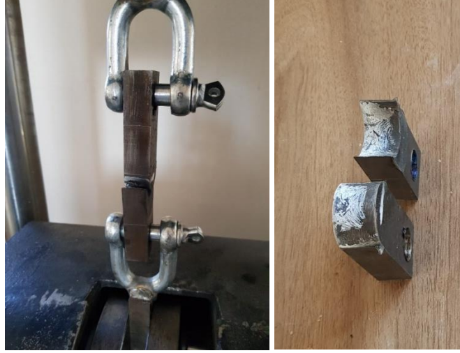
Şekil 2.10. Çekme deneyi sonucunda bağlantısının kopması
