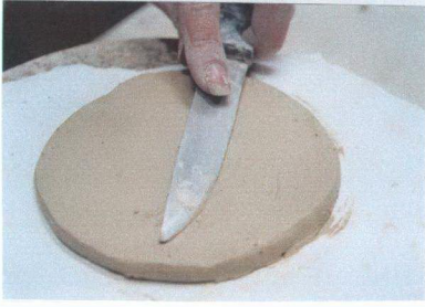
Resim 9- Çentilen Yüzeyin Düzaltılması
