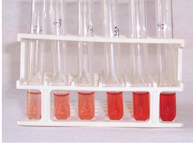
Şekil-19. Kongo red ile elastaz varlığında oluşan renk değişimi.
