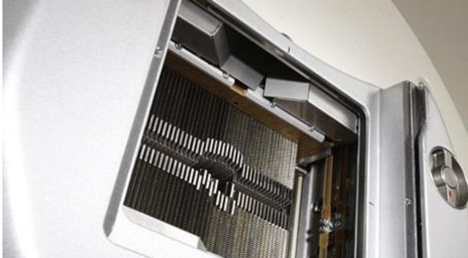
Şekil-5: Siemens 160 lif ÇYK yapısı. ( www.siemens.com/healthcare )
