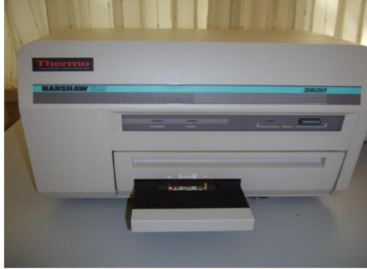
Şekil-19: Harshaw (Thermo Electron Corporation, 3500, USA) marka TLD okuyucu.
