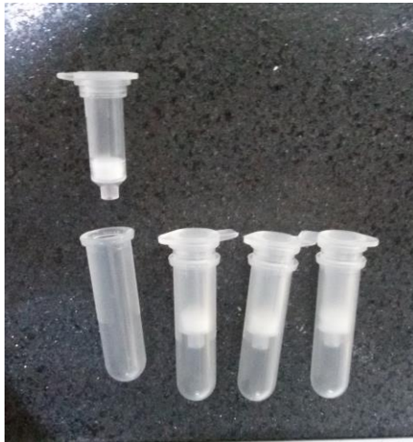
Şekil 3. DNA ekstraksiyonunda kullanılan spin kolon filtreler
