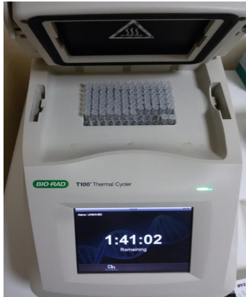
Şekil 4. PCR çalışmalarında kullanılan Thermal Cycler (Biorad T100)
