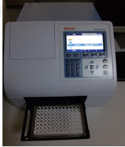
Şekil 5. DNA konsantrasyon ve MİK dilüsyonlarının ölçülmesinde kullanılan MultiScan Go(Thermo)
