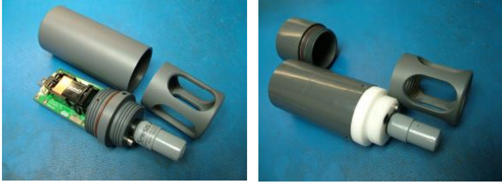
Şekil 15. Dascor LRCpH sistemi açık ve kapalı halde
