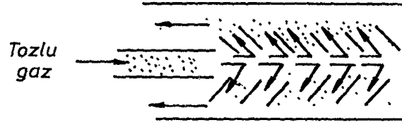
Şekil-2.36. Bir atalet ayırıcının çalışma prensibi /MUEZZİNOĞLU (1987)/
