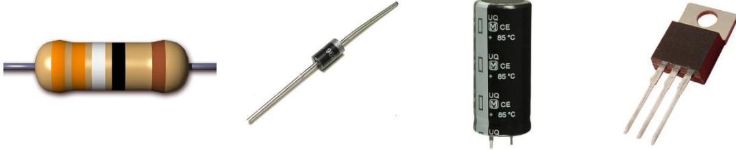
Şekil 3.5: Bazı devre elemanları (Direnç – Diyot – Kondansatör - Transistor) [41]
