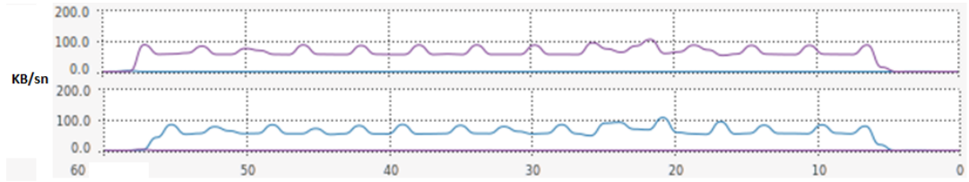
Şekil 5.3: 720p çözünürlükteki avi formatlı verilerin (KB) transfer ve gecikme süresi (1.88 sn) Bilgisayar (üst) –PandaBoard (alt)
