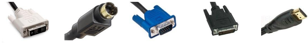
Şekil 1.2: Bazı projeksiyon cihazı giriş standartları (DVI – Svideo – VGA - M1 - HDMI) [6].
