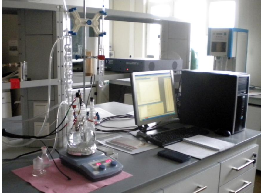
Şekil 4.7: Çalışmada kullanılan elektrokimyasal reaksiyon hücresi, potansiyostat ve PC.
