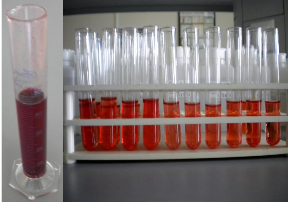
Şekil 4.52: UV-görünür bölge spektrofotometre analizinde kullanılan baz boya çözeltisi ve boyalı test çözeltileri.
