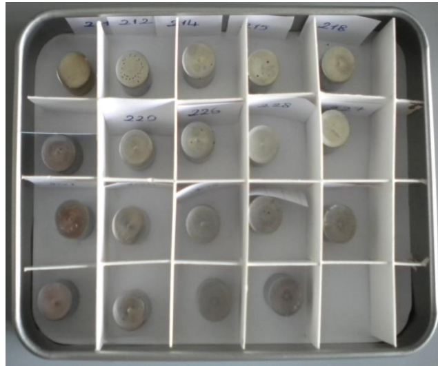
Şekil 4.6: Potansiyodinamik polarizasyon testleri yapılmış AISI 316L paslanmaz çelik numuneler.
