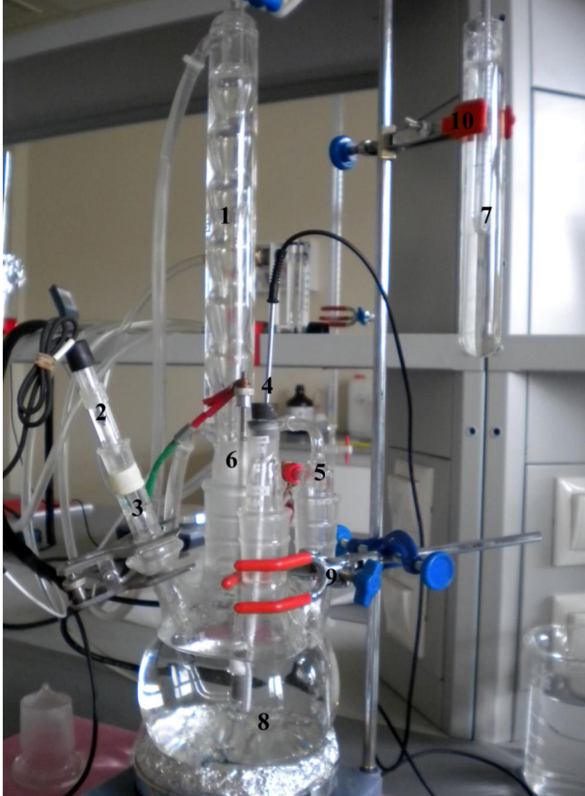
Şekil 4.1: Çalışmada kullanılan elektrokimyasal reaksiyon hücresi ve diğer ekipmanlar.
