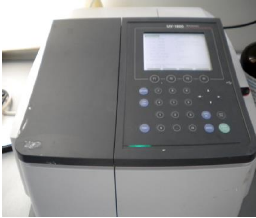
Şekil 4.54: UV-görünür bölge spektrofometre analizinde kullanılan spektrofotometre cihazı.
