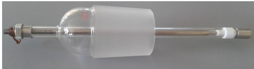
Şekil 4.5: ASTM G5 numune tutucu ve paslanmaz çelik numune.
