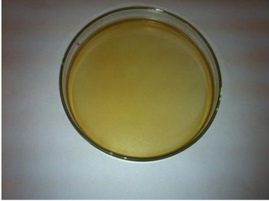
Şekil 5. 6 : Gliserol ile hazırlanan glisidil POSS modifiyeli ksilan filmi.
