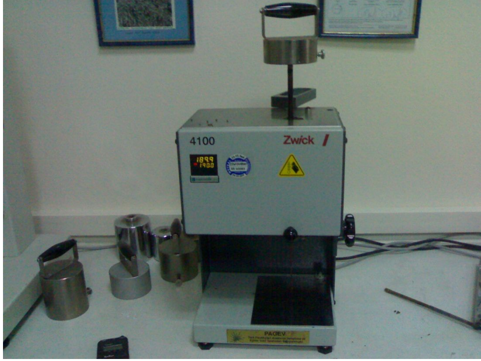
Şekil 4.20 : Kullanılan erime akış indisi test cihazı.
