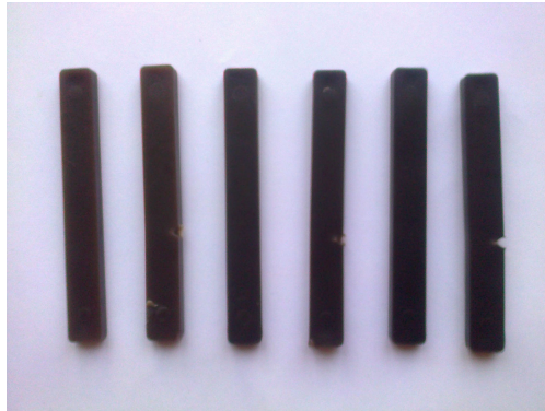
Şekil 4.15 : 3 farklı malzemenin çentikli ve çentiksiz darbe çubukları.
