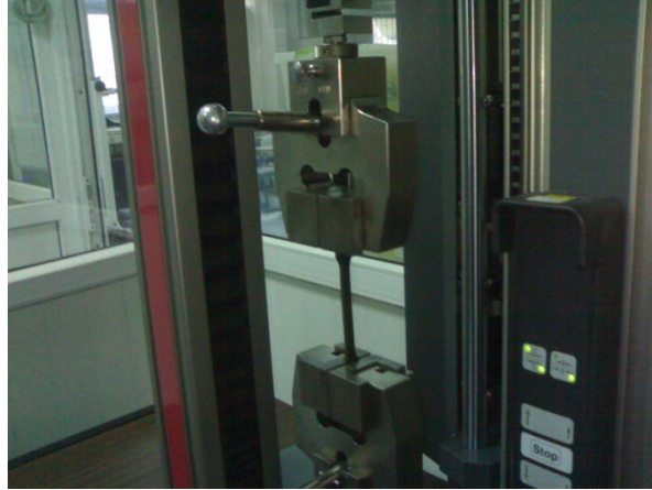
Şekil 4.14 : Kullanılan çekme cihazı.
