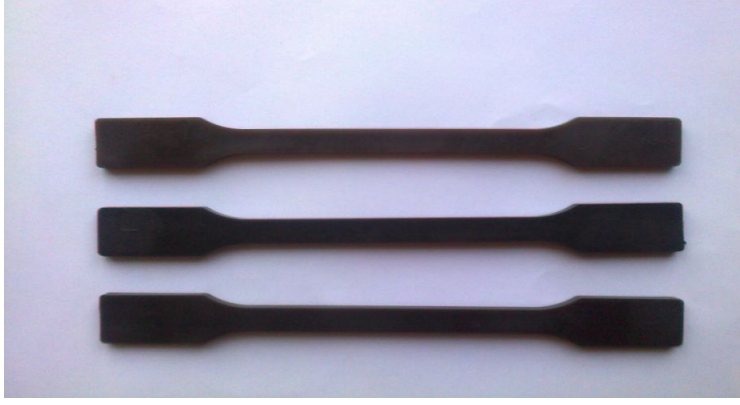
Şekil 4.13 : Üç farklı malzemedan kalıplanan çekme çubukları.
