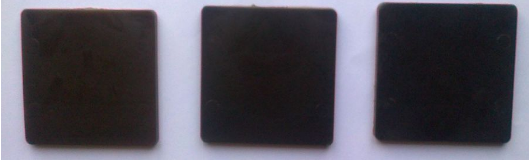
Şekil 4.19 : Sertlik ölçümleri için üretilen test numuneleri.
