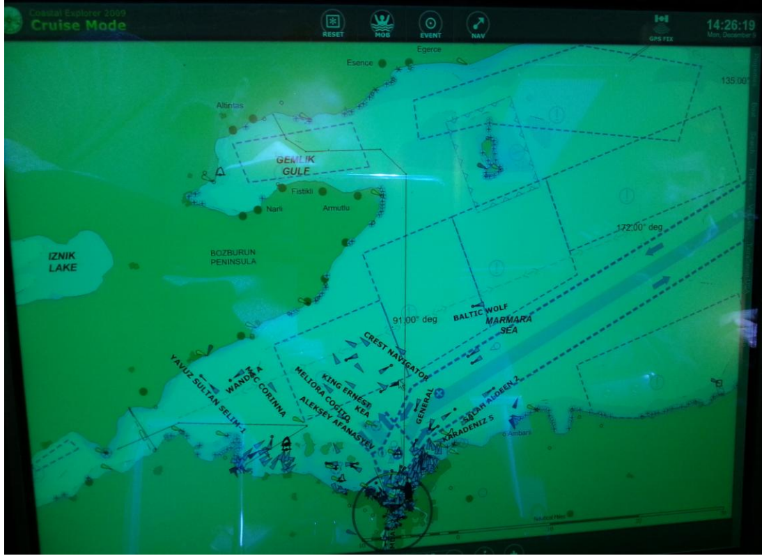
Şekil 5.2 : Osmangazi-1 gemisi elektronik harita üzerinde rota planlaması
