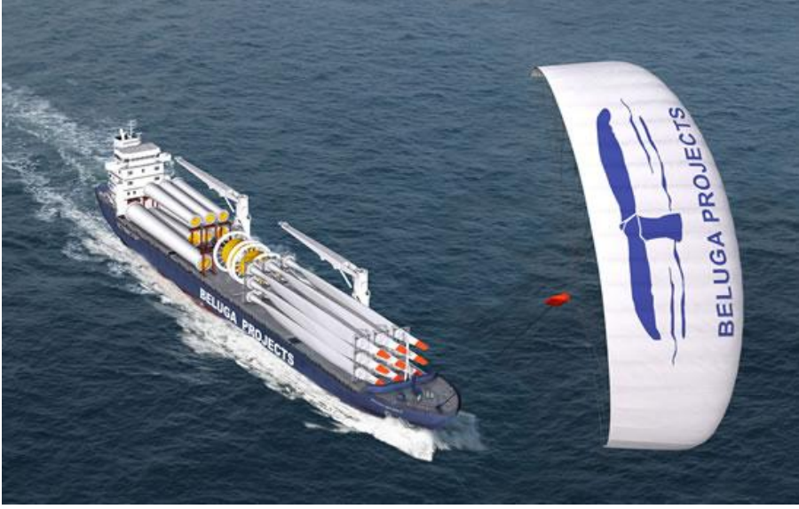
Şekil 4.3 : Gemilerde kullanılması planlanan rüzgâr paraşütü örneği 35
