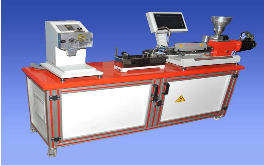
Şekil 6. 2 : 16mm çift vidalı ekstrüder.
