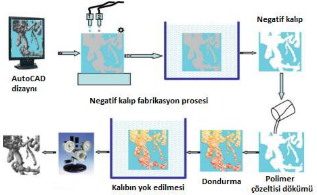
Şekil 2.8: Katı serbest form fabrikasyonu indirekt yöntem
