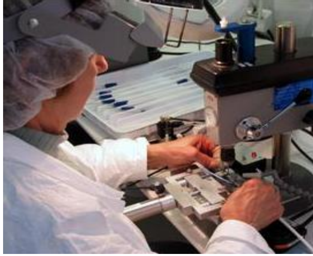
Şekil 2.1. Mikro frezeleme ile işleme [1].
