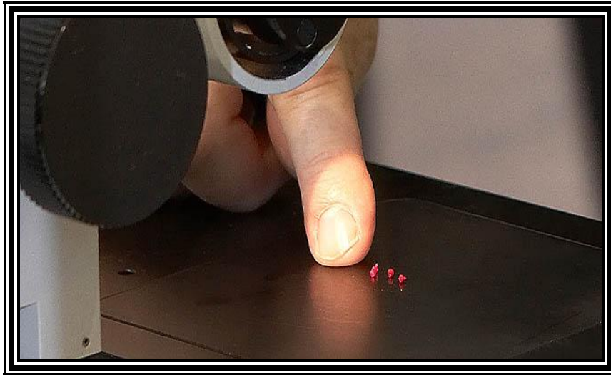
Şekil 2.11. Mikroskopla Mikro dişli örneklerinin incelenmesi [27].
