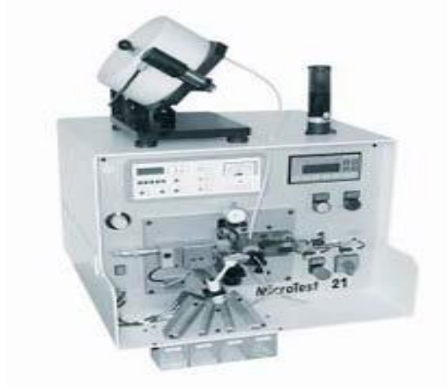
Şekil 2.8. Otomatik kalite kontrol makinesi, 100% güvenlik garantisi, mekanik kontrol, \pm 0.15 \mu\text{m} doğruluk ve tekrarlılık, otomatik kalite seçimi (4 grup), ortalama 10 sn çevrim zamanı [11].
