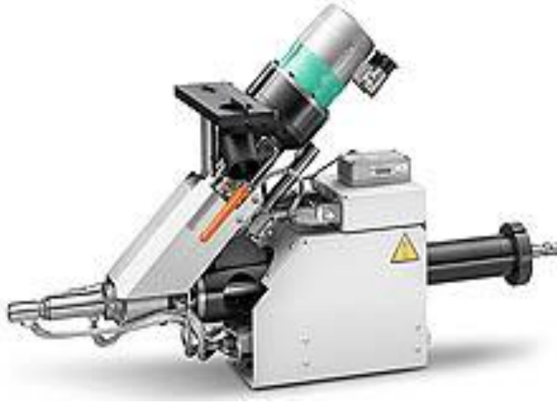
Şekil 3.6. Mikro enjeksiyonda plastik akış kontrolü (dozajlama) ünitesi[29].
