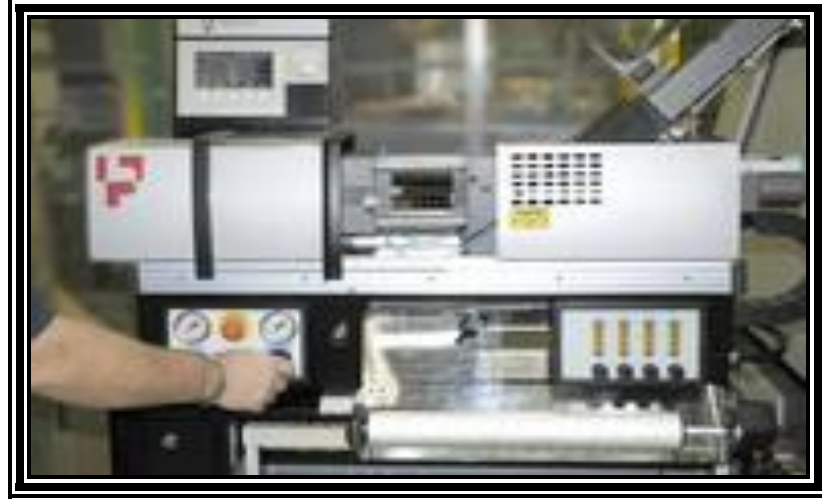
Şekil 3.2. Mikro enjeksiyon makinesi [28].
