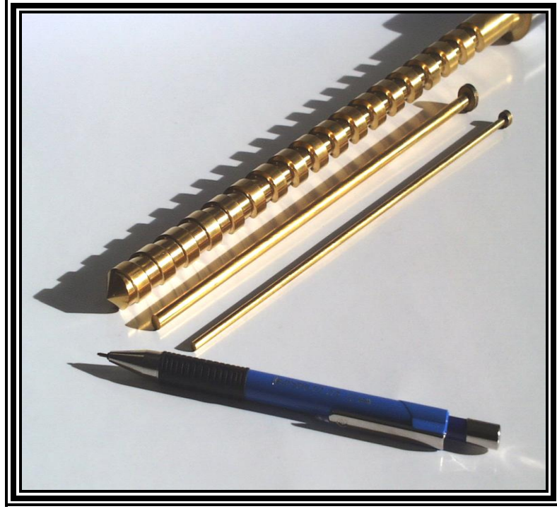
Şekil 3.3. Ekstrüder vidası (Çapı 14 mm ve enjeksiyon gramajı 1.0 g) [1].
