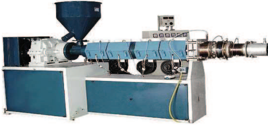
Şekil 3.5 : Karışımlarda kullanılan ekstruzyon makinesi
