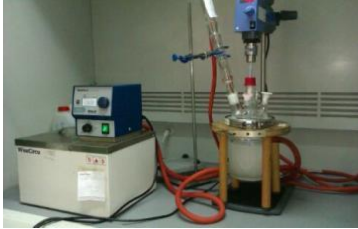
Şekil 3.4: Poli(GMA-ko-BDDMA) ve poli(GMA-ko-BDDMA)/pullulan poliHIPE mikrokürelerinin hazırlanmasında kullanılan reaksiyon sistemi.
