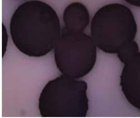
Őekil 4.11: Sűspansiyon ortamında stabilizatűr olarak (a) %0.2, (b) %0.6 ve (c) %1.0 oranında pullulan kullanılarak hazırlanan poli(GMA-ko-BDDMA) poliHIPE mikrokűrelerinin POM gűrűntűsű.
