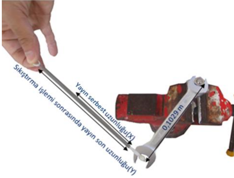
Şekil 3.10: Örneği belirlenmiş Tork altında sıkıştırmak için kullanılan yaylı düzenek
