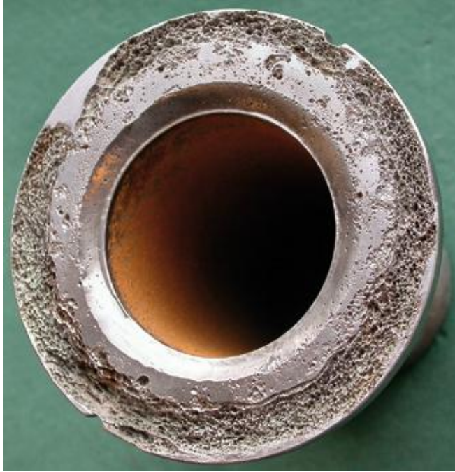
Şekil 2.8: Malzeme yüzeyindeki aralık korozyonu görüntüsü.
