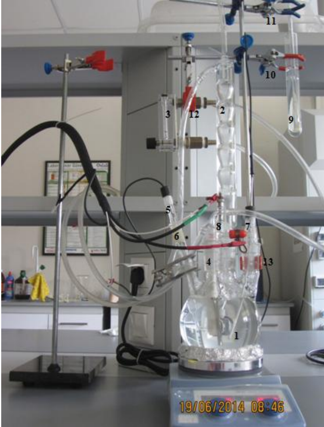
Şekil 3.1: Çalışmada kullanılan elektrokimyasal korozyon hücresi ve diğer ekipmanlar.
