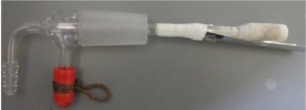
Şekil 3.3: Purge tüpü ve 14 cm 2 yüzey alanlı platin elektrot.
