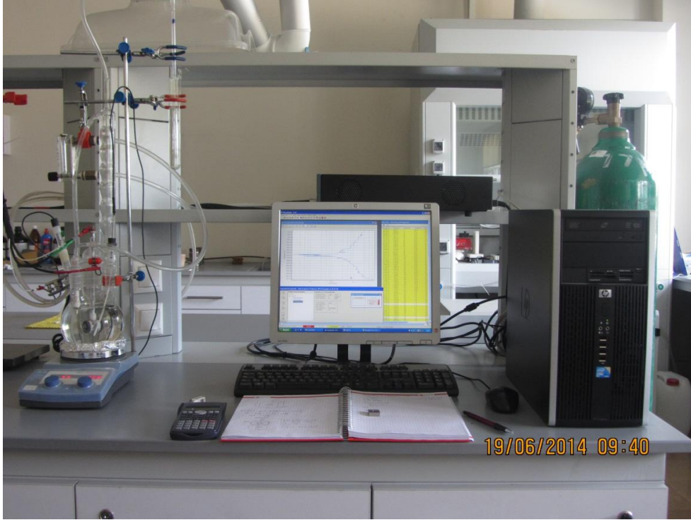
Şekil 3.12: Çalışmada kullanılan elektrokimyasal reaksiyon hücresi, potansiyostat ve PC.
