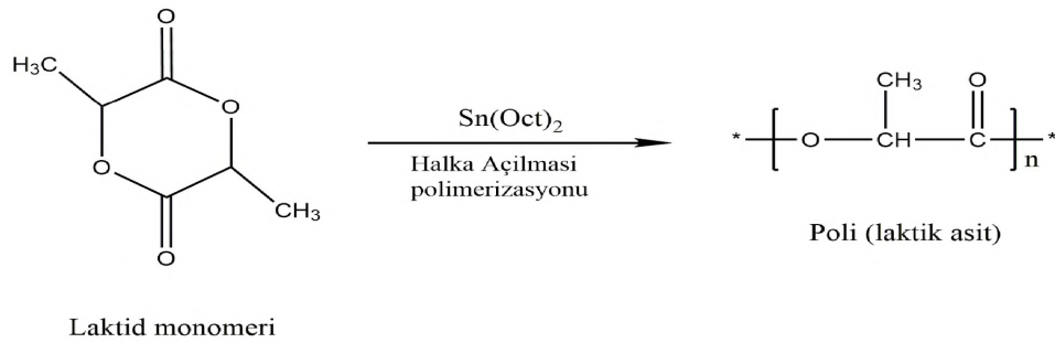
Şekil 2.20: PLA'nın halka açılması polimerizasyonu
