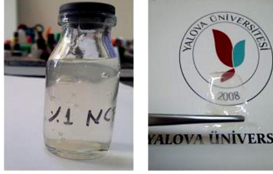
Şekil 3.7. Hazırlanan NFC çözeltisi ve nanosayfa örneği
