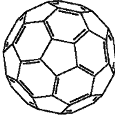
Şekil 3.5 : C_{60} molekülünün bağ yapısı
