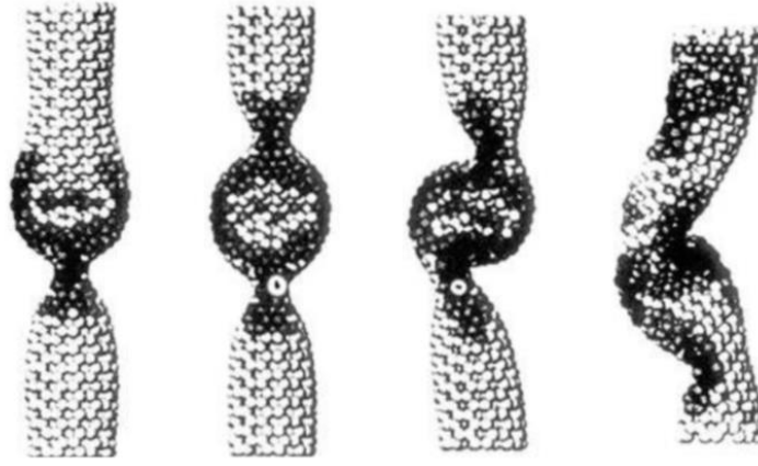
Şekil 3.15 : Tek Duvarlı Nanotüpün Elastikiyeti
