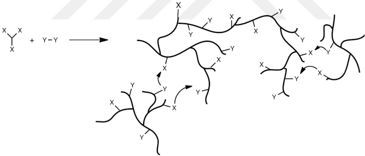
Şekil 1.2 : A 3 ve B 2 kondenzasyon monomerleri tarafından sentezlenen yüksek dallanmış bir polimerin reaksiyon mekanizmasının şematik gösterimi
