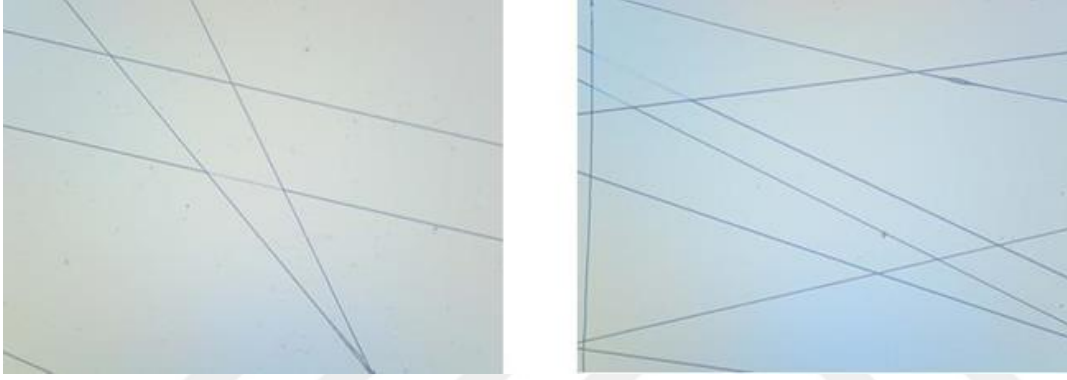
Şekil 4.7. %25 (g/ml) konsantrasyonda PGS:PCL (1:1) çözeltisinden 22 kV gerilim uygulanarak elde edilen fiberlerin optik mikroskop görüntüleri; x20 (sağ) ve x20 (sol)
