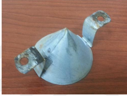
Şekil 3.5 : Akış düzeltici konik plaka.
