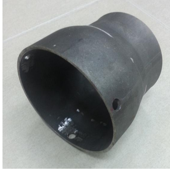
Şekil 3.35 : K-3 tipi indüksiyonlu hava ısıtıcısının çıkış kapağı (konsantrik redüksiyon) görüntüsü.
