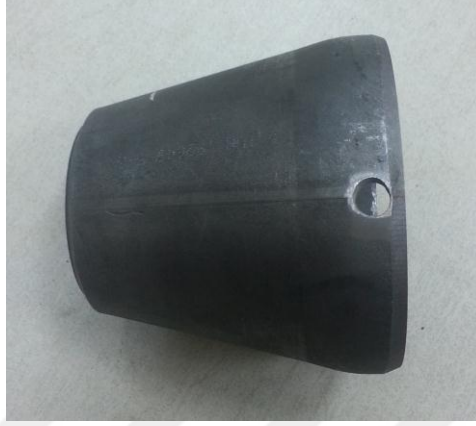
Şekil 3.16 : K-2 prototipinin çıkış kapağı (konik redüksiyon) görüntüsü.
