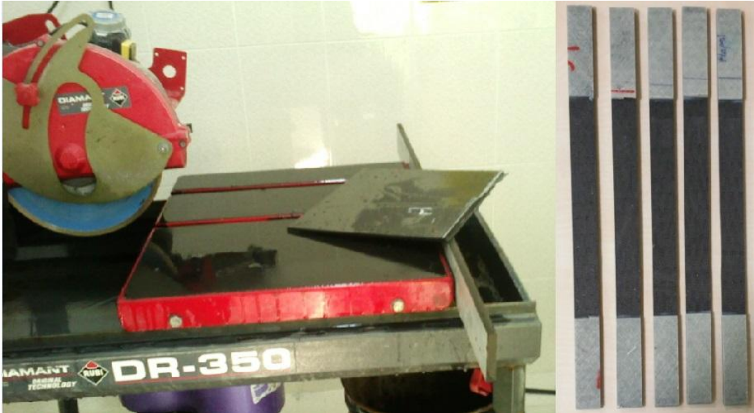
Şekil 3.16: Karbon kompozit test numunelerinin hazırlanması
