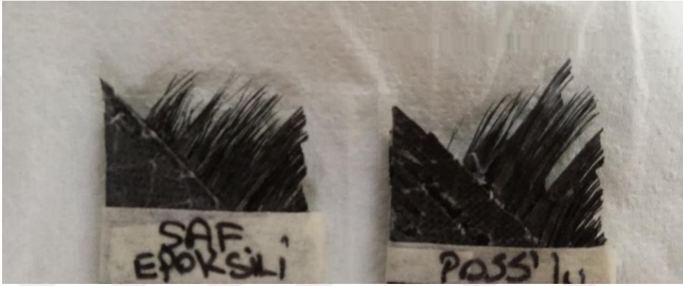
Şekil 4.13: Mekanik testler sonrası hasar alan elyaf takviyeli kompozit yüzeyleri
