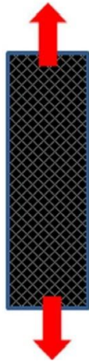
Şekil 3.18: Karbon elyaf takviyeli POSS/epoksi nanokompozit numunesi düzlem içi kayma testi
