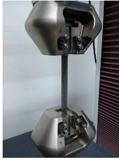
Şekil 3.18: Karbon elyaf takviyeli POSS/epoksi nanokompozit numunesi düzlem içi kayma testi
