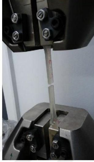
Şekil 3.17: POSS/epoksi nanokompozit numunesi çekme testi
