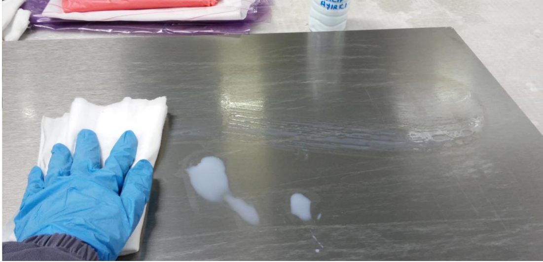
Şekil 3.5: Kalıp yüzeyine kalıp ayırıcı uygulaması
