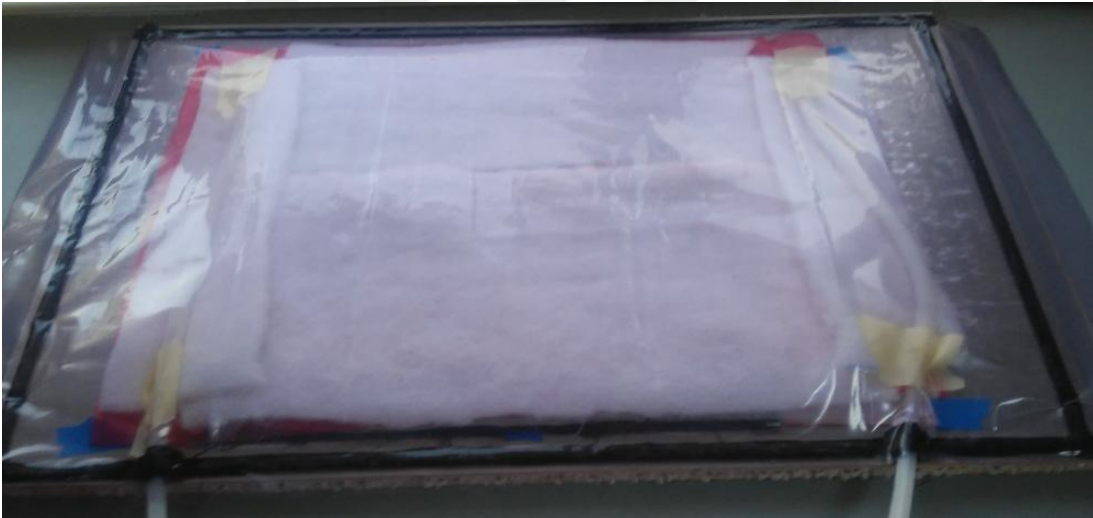
Şekil 3.12: Sistemin vakum naylonu ile kapatılması
