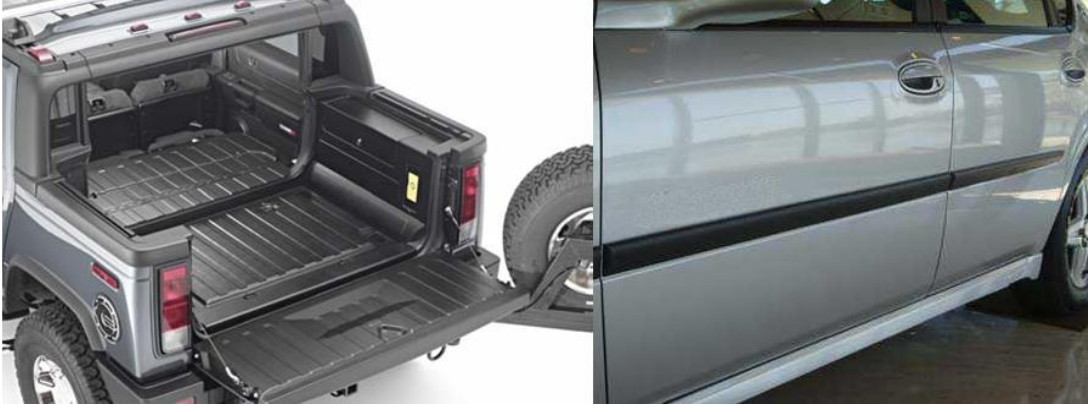
Şekil 2.5: Polimer/kil nanokompozitlerden üretilmiş otomotiv parçaları
