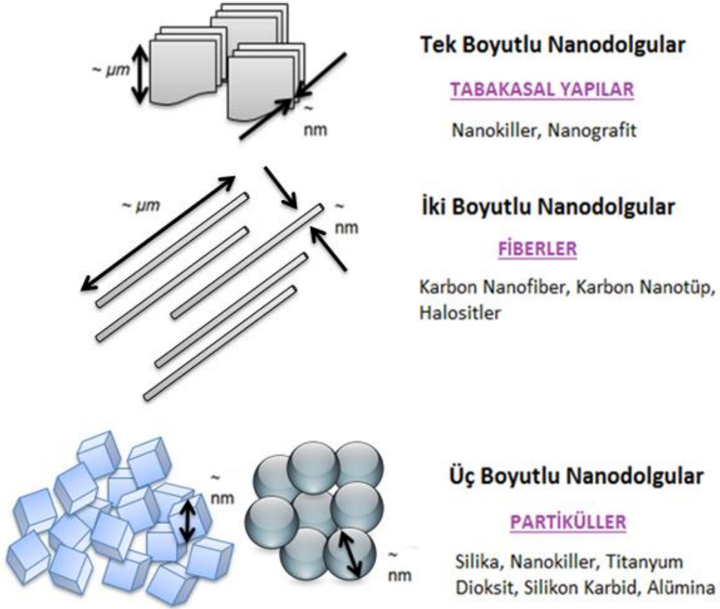
Şekil 2.4: Nanokompozit malzemelerde dolgu olarak kullanılan materyallerin fiziksel yapıları
